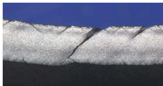
Obr. 79 Detail průchozí trhliny
