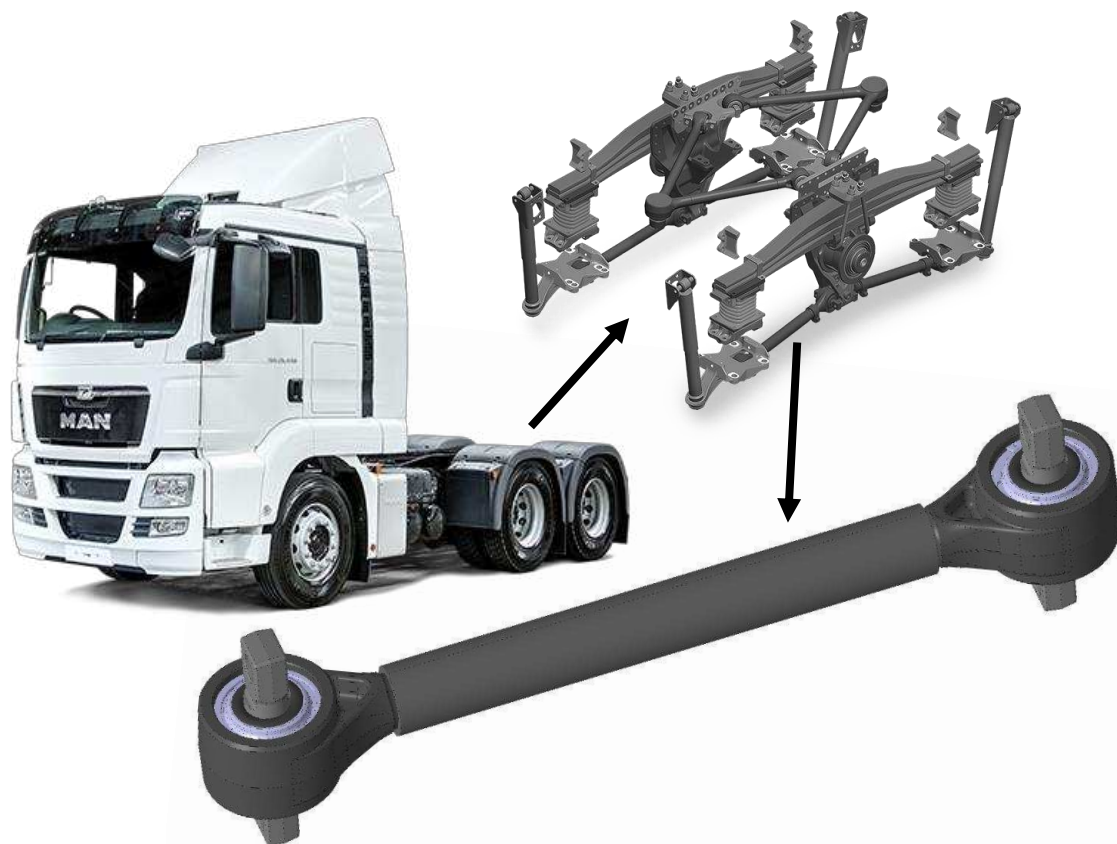
Obr. 2 Umístění vodícího táhla v nákladním automobilu [3], [4], [5]
