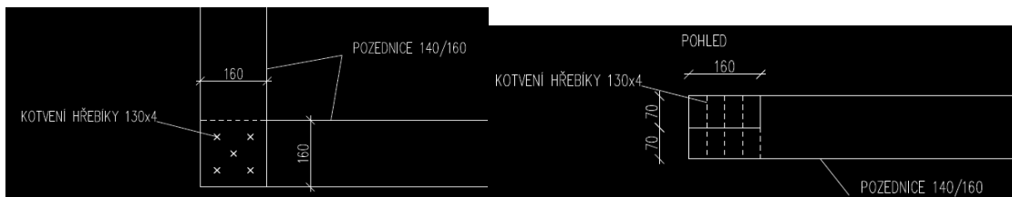
Obrázek 82. Koutové spojení vaznic
