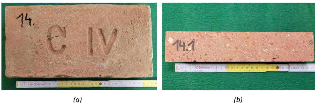
Obr. 49. Příprava zkušebních vzorků; (a) historická cihla plná pálená s označením č. 14 z poloviny 19. století; (b) zkušební trámec vytvořený z cihly č. 14 po 25 zmrazovacích cyklech.
