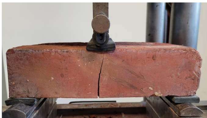
Obr. 27. Stanovení pevnosti v tahu za ohybu dle ČSN 72 2605.
