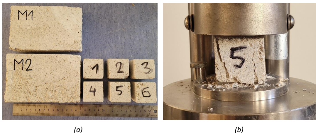
Obr. 46. Stanovení pevnosti v tlaku malty [153]; (a) Zkušební tělesa 1 ÷ 6 pro destruktivní stanovení pevnosti v tlaku a tělesa M1 a M2 pro stanovení semidestruktivní pevnosti v tlaku vrtačkou KV-3; (b) zkušební těleso č.5 po dosažení maximální síly.
