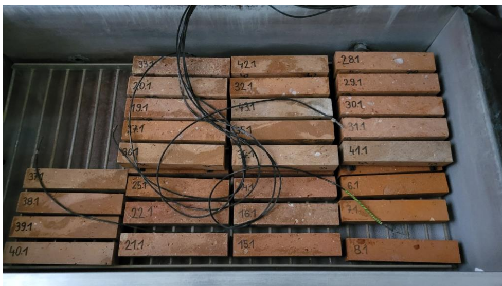
Obr. 25. Zkouška mrazuvzdornosti dle ČSN 72 2609 - reprezentativní vzorky uložené v automatické zmrazovací skříni KD 20.
