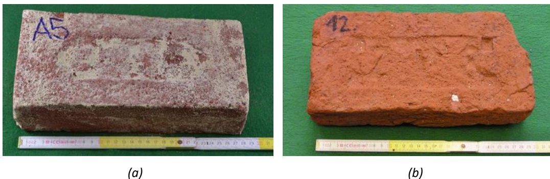
Obr. 4. Vliv teploty výpalu na vzhled cihly; (a) cihla s vysokou teplotou výpalu; (b) cihla s nízkou teplotou výpalu [7].
