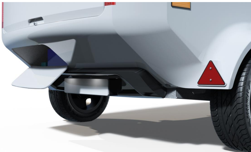
Obr. 6- 35 Po vyklopení servisních dvířek získá uživatel přístup k baterii
