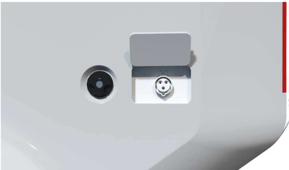
Obr. 6- 11 Víčko nádrže pro doplnění nafty k topení a zásuvka 230 V pro připojení elektrického obvodu ze sítě
