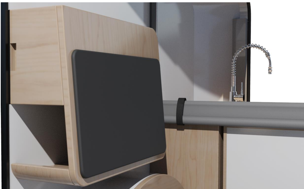
Obr. 6- 25 Úložný prostor v zádové opěrice na levém boku interiéru
