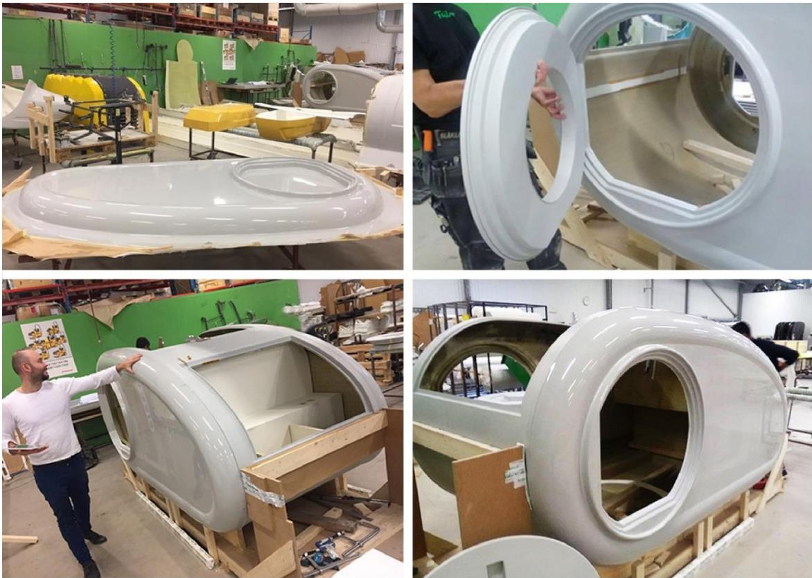
Obr. 2- 27 Výroba sklolaminátové stěny karavanu MINK [31]
