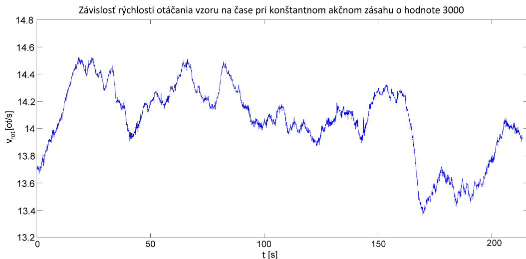
Obr. 2.7: Závislosť rýchlosti otáčania vzoru na čase pri konštantnom akčnom zásahu o hodnote 3000
