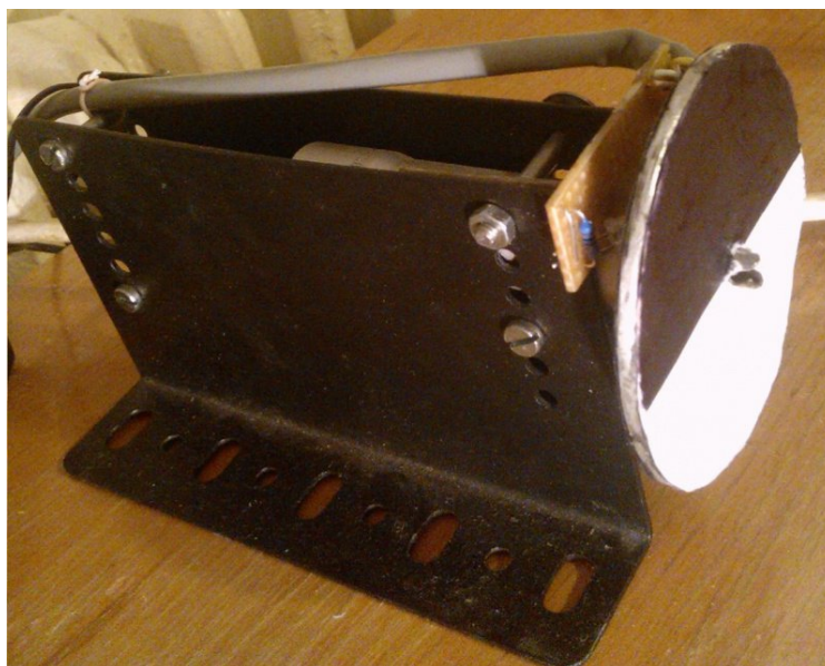
Obr. 2.3: Časť prípravku s motorom a optickým snímačom otáčok.
