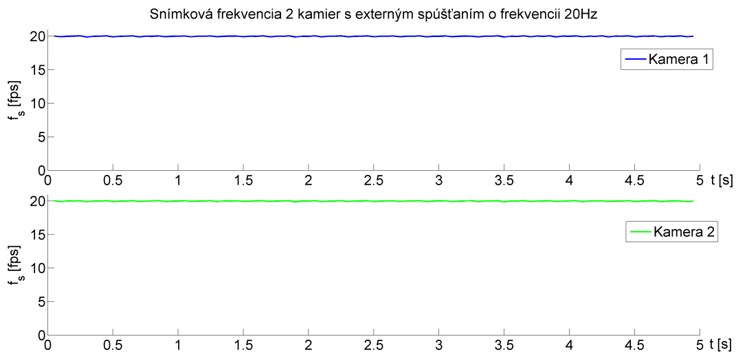
Obr. 4.5: Snímková frekvencia 2 kamier s externým spúšťaním snímania o frekvencii 20 Hz
