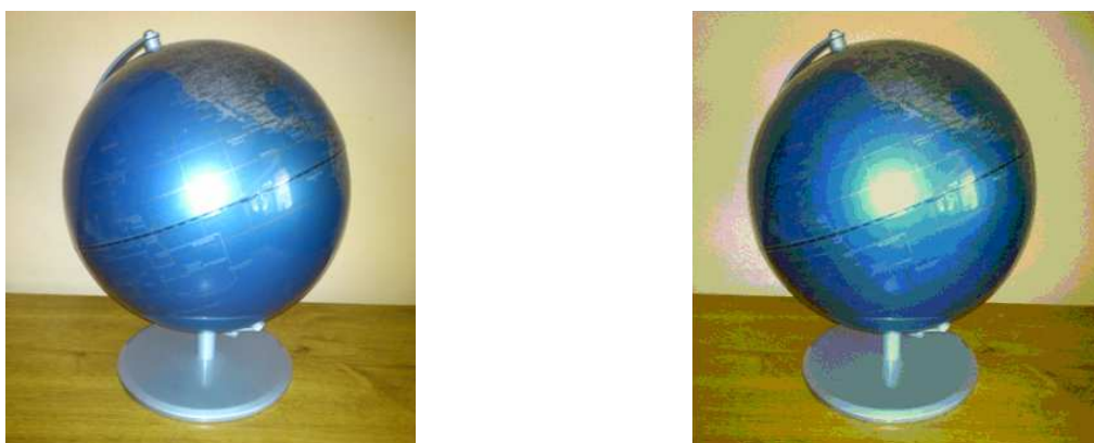
Obrázek 2.6: Porovnání barevného obrazu v RGB888 (vlevo) a RGB332 (vpravo).
