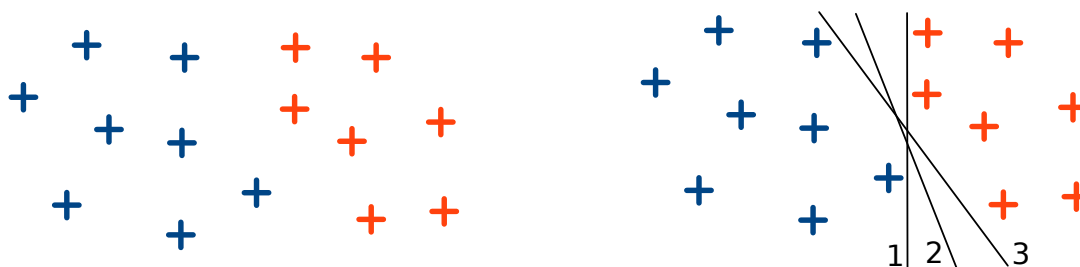
Obrázek 2.16: Lineární klasifikátor. Vlevo je příklad vstupních dat, na kterých je klasifikátor natrénován. Napravo je pak několik možných rozhodovacích linií vzniklých po natrénování takového klasifikátoru.
