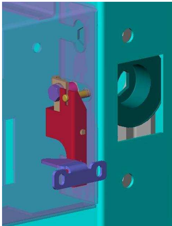
Obr. 2-5 Blokování zkratovače dveřmi kabelového prostoru
