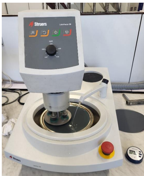
Obrázek 12: Proces broušení na zařízení Struers Labo Force-50
