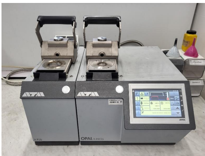
Obrázek 11: modulární metalografický lis ATM Opal X-Press
