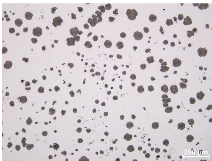
Obrázek 40: Mikrostruktura vzorku (02) v příčném řezu – neleptaný stav
