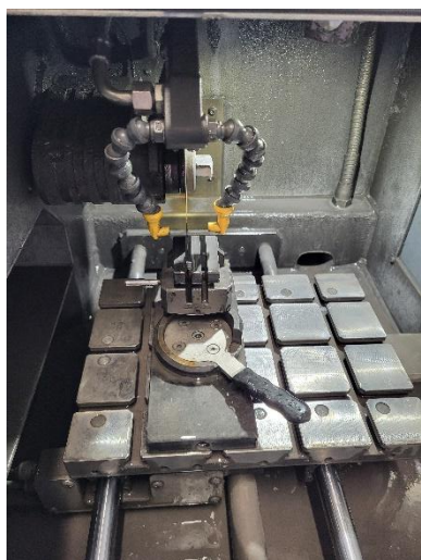
Obrázek 10: Dělení vzorku na metalografické pile ATM Brillant 220
