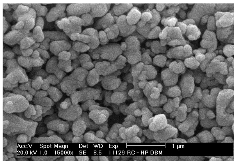
Obr. 4.2. Tvar a distribuce částic RC-HPDBM pořízené SEM[14].
