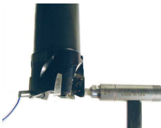
Obr. 5.3 Ukázka modální analýzy na čelní válčové fríze [44].
