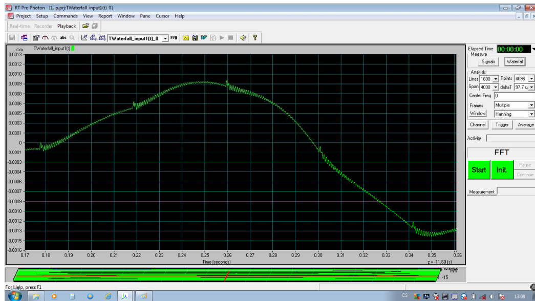
Obr. 8.26 Závislost výchylky na čase se znatelným nájezdem zubu do záběru v softwaru RT PRO PHOTON.
