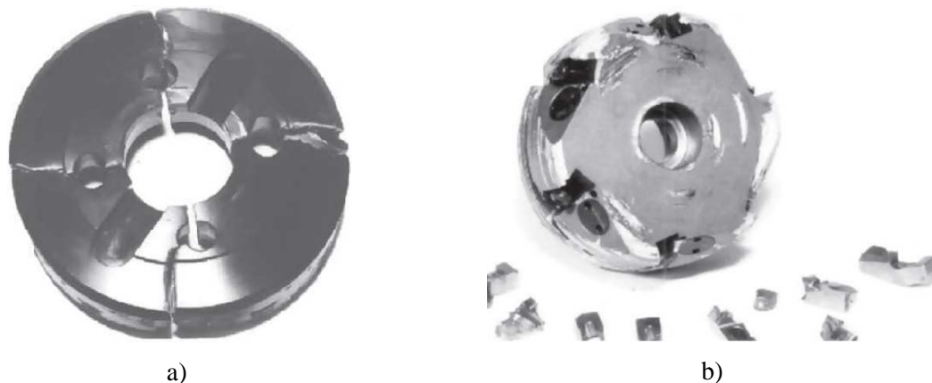
Obr. 3.13 Příklad destrukce nástroje: a) selhání základního tělesa, b) selhání kazety [41].
