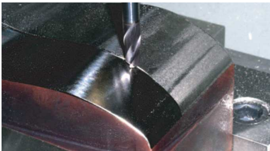
Obr. 3.6 Příklad tvrdého obrábění oceli (ČSN 19 552) zušlechtné na 56 HRC [30].
