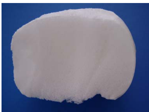
Obrázek 9: Testovaný vzorek PUF s bio-polyolem sodnou solí karboxymethylcelulózy
