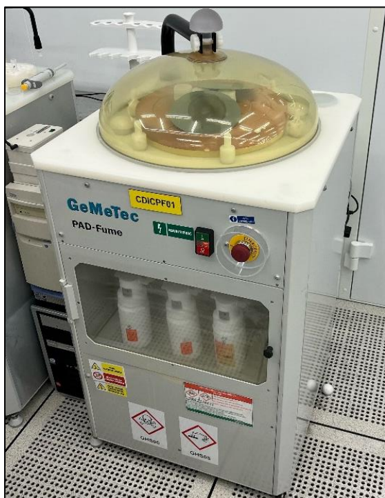
Obrázek 17: Zařízení Pad-Fume. Horní část tvoří kopule odolná parám HF a ve spodní části přístroje se nachází zásobní láhev s HF.
