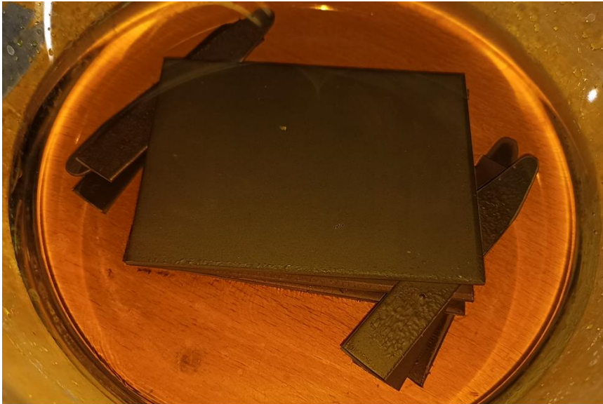
Obr. 15 – Fotodokumentace korozní lázně
