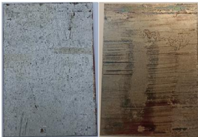
Strojní nátěr s lehkou korozi
