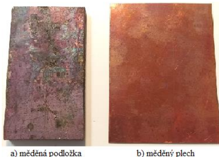
Obr. 21 – Fotodokumentace očištěných vzorků koroze mědi
