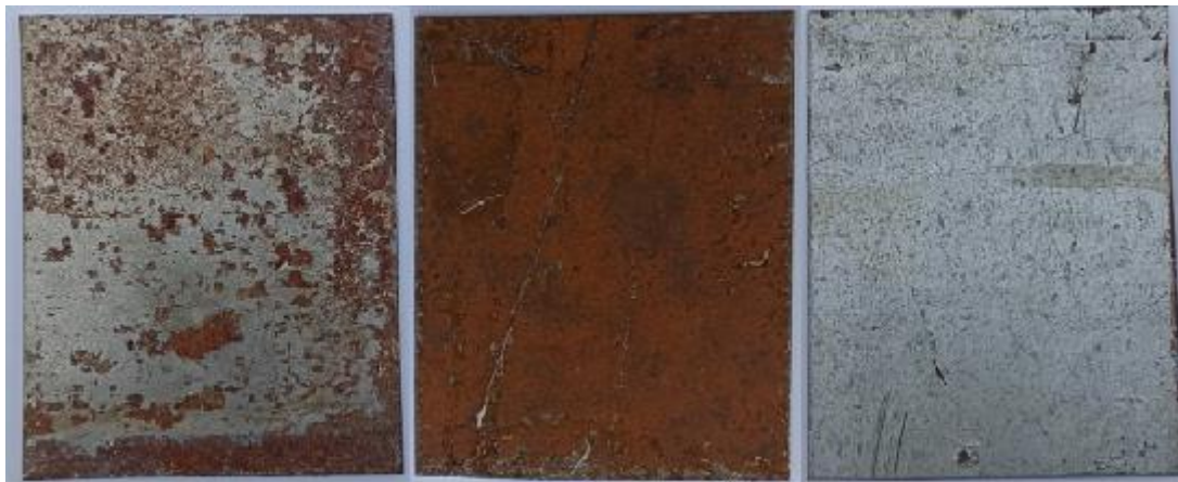
a) lokální koroze
