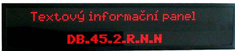
Obr. 5-1 Informační LED panel, výška znaku 45 mm, 2x24 znaků
