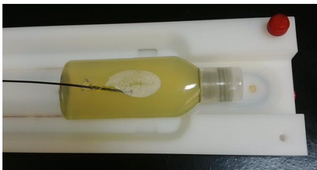
Obr. 25: Fantom uložený na lůžku se zavedenou teplotní sondou.
