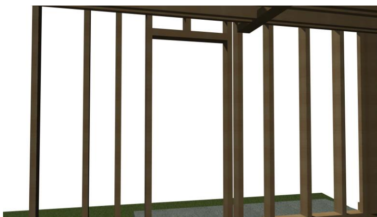
Obrázek 4.7.2 – Rámová konstrukce s otvorem pro dveře [2]
