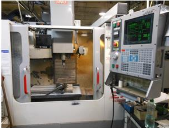
Obr. 6.3 Pohled do pracovního prostoru CNC obráběcího centra VF0 Haas.
