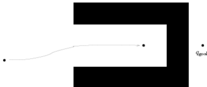
Obrázek 6 - Riziková situace uvíznutí robota v lokálním minimu
