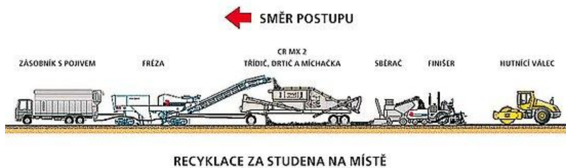
Obr. 3.6 Schéma recyklace na místě za studena [10]
