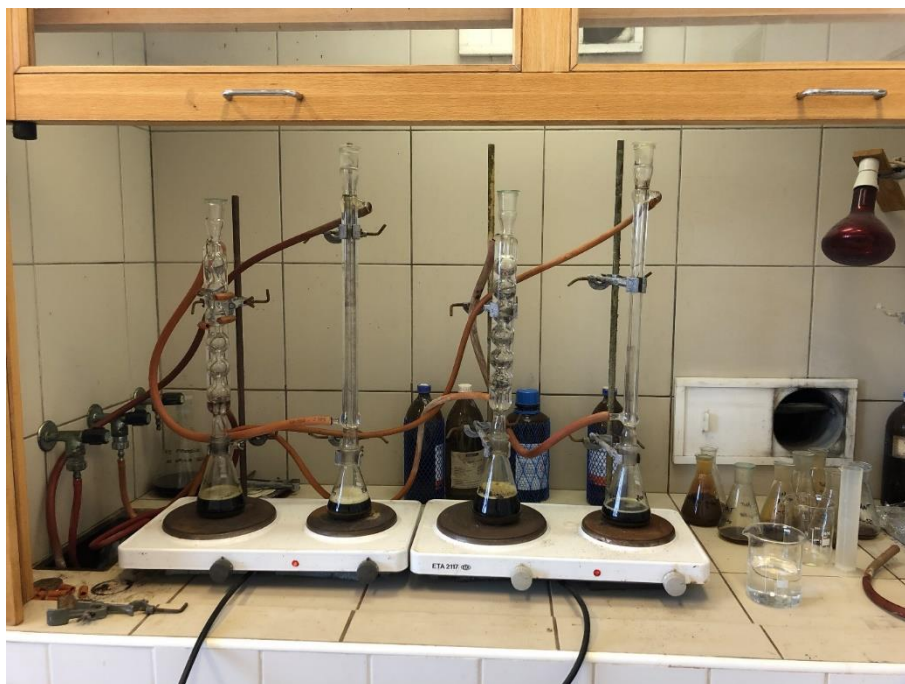
Obrázek 12. - Kolona pro extrakci platinových kovů
