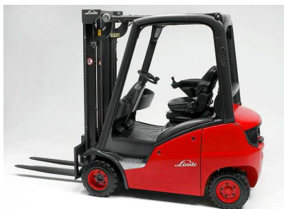
obrázek 18 - Motorový vozík s nosností 2,5t
