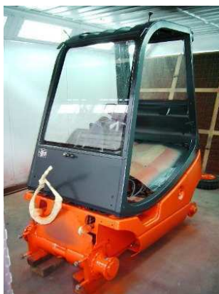
Obr. 22 - Použitý vozík v průběhu opravy
