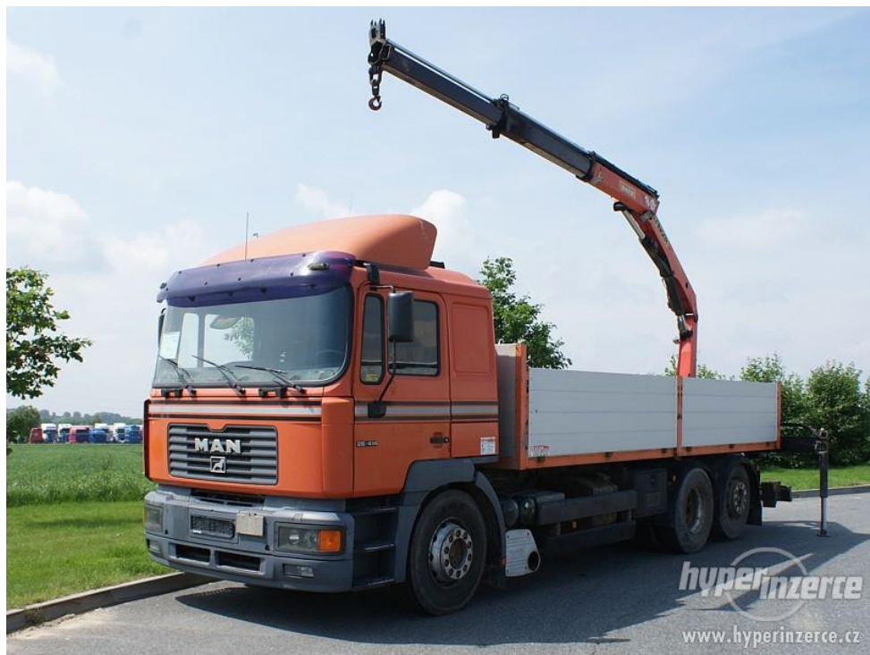
Obr. 39 Nákladní automobil MAN 26.414 s valníkem a hydraulickou rukou HIAB 200 C-4
