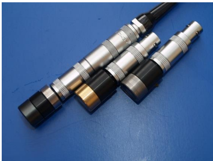
Obr. 4.2 Sondy vířivých proudů pro kontrolu kompozitních uhlíkových materiálů
