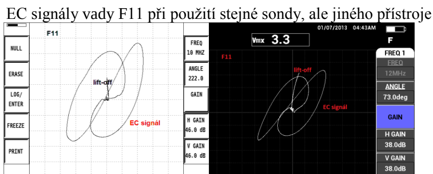
Obr. 5.7 EC signály vady F11 při použití stejné sondy, ale dvou odlišných přístrojů
