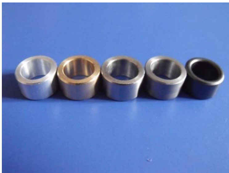
Obr. 4.1 Stínící kroužky v pořadí hliník, mosaz, austenitická ocel, slitina železa, ferit
