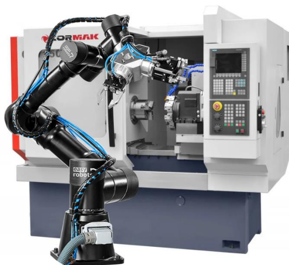
Obr. 5, Robot spolupracujúci so sústruhom[15]
