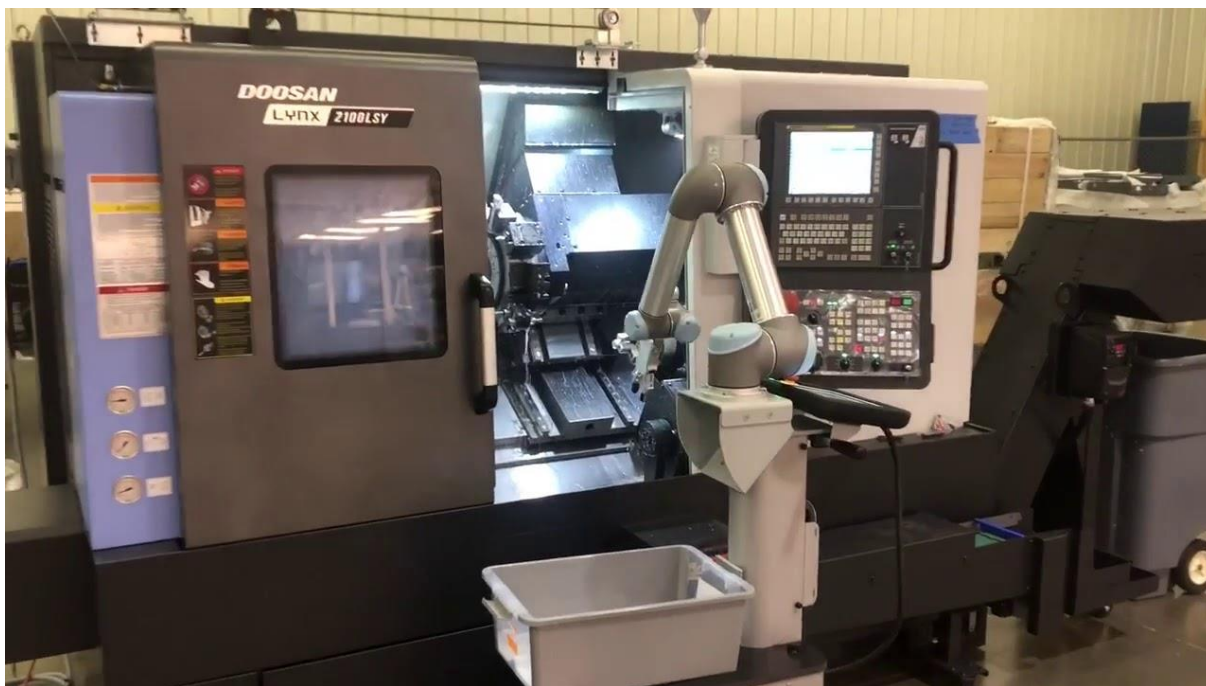
Obr. 7, COBOT spolupracujúci so sústruhom[24]
