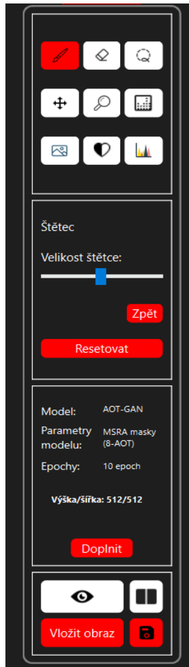
Obrázek 3.3: Nástrojová lišta. V prvním bloku se nacházejí tlačítka s použitelnými nástroji. V druhém bloku se vždy zobrazí proveditelné akce v závislosti na zvoleném nástroji. Následuje blok s parametry pro image inpainting. Kliknutím do této části se vyvolá dialogové okno pro jejich nastavení a tlačítko Doplnit zahájí inpainting. V posledním bloku se nacházejí tlačítka pro zapnutí/vypnutí masky, změnu módu, vložení nového obrázku a tlačítko pro jeho uložení.
