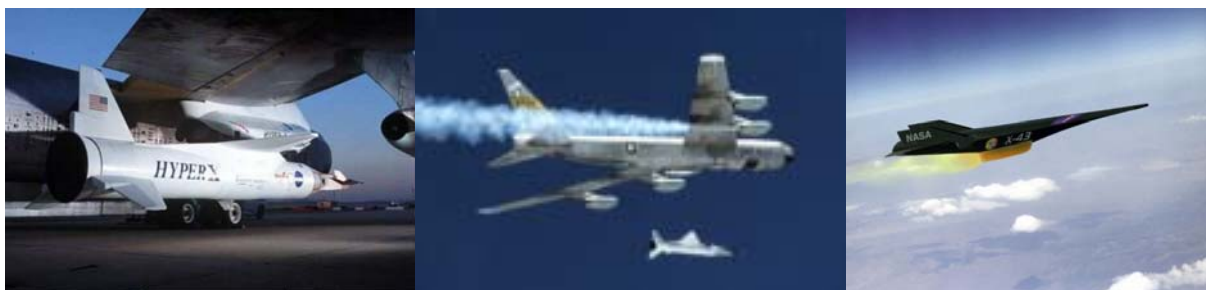
Obr. 4.4 S tímto scramjetem překonalo letadlo X-43 rychlost 10 000 Km/h [23] [23] [24]
