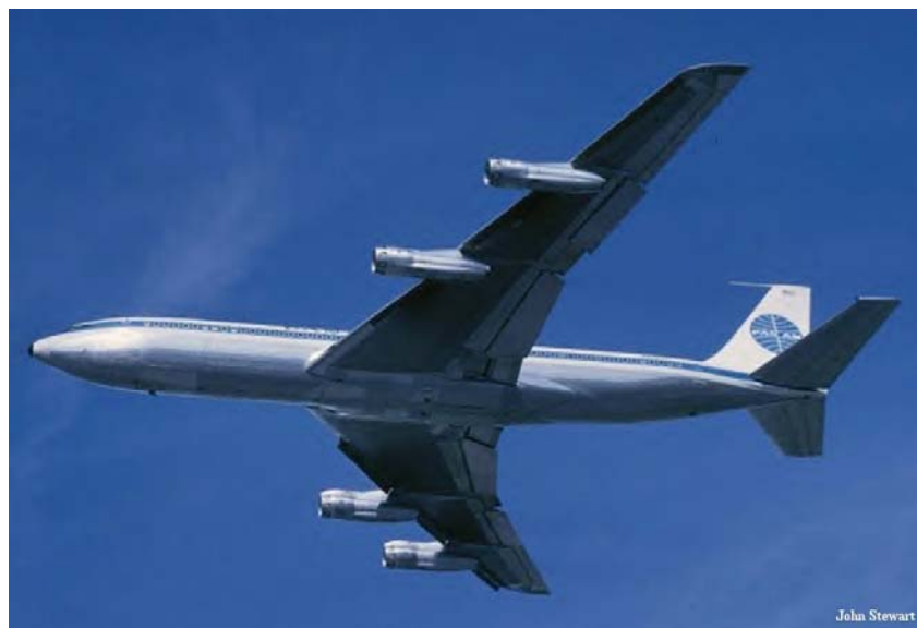
Obr. 4.7 Jedna z prvních verzí Boingu 707-121 měla dvouproudové motory JT3C-6
