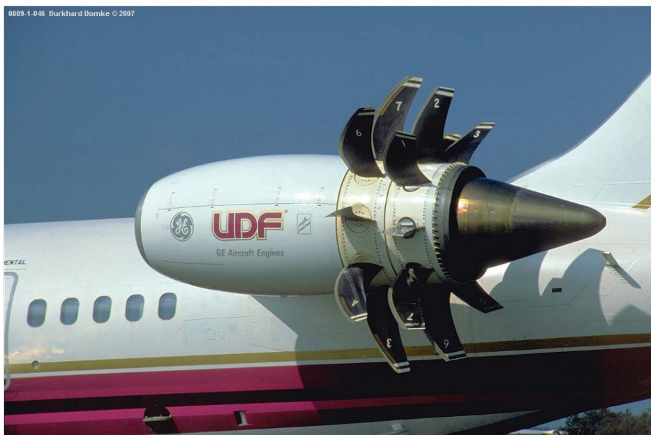
Obr. 4.10 Motor G36 UDF testovaný na MD-80
