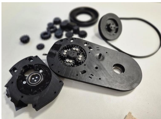
Obr. 11: Oprava převodového ústrojí diferenciálního zápěstí
