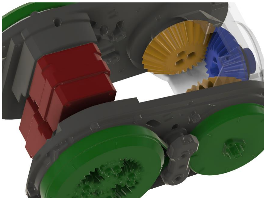
Obr. 5: Diferenciální zápěstí manipulátoru
