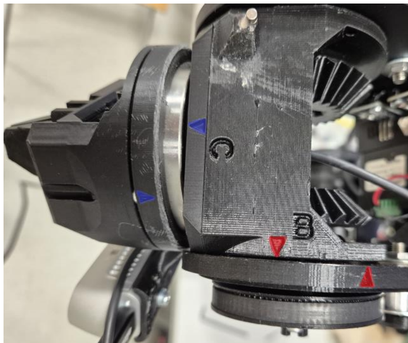
Obr. 12: Odchylka způsobená ztrátou informace o natočení zápěstí
