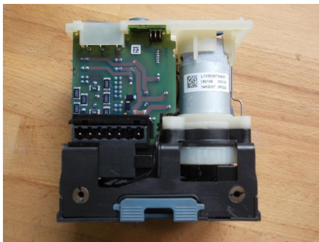
Obrázek 7. - Pohled na elektroniku a stejnosměrný motor pohonu
