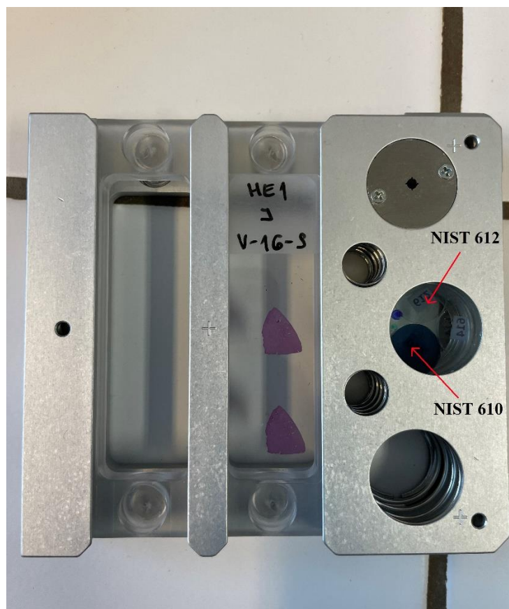
Obrázek 11: Držák laserové ablační komory se vzorkem (V-16-S) a standardními referenčními materiály
