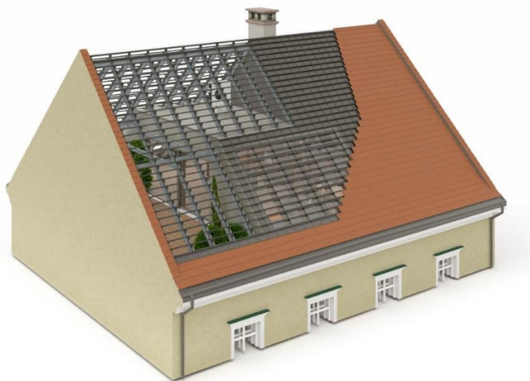
Obrázok 21 Konštrukčný systém zastrešenia [17]
