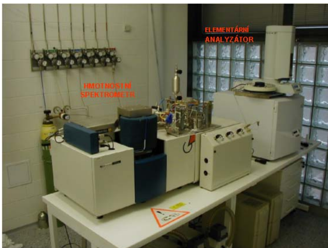
příloha 1. EA IRMS – hmotnostní spektrometr izotopových poměrů v laboratoři SZPI v Brně
