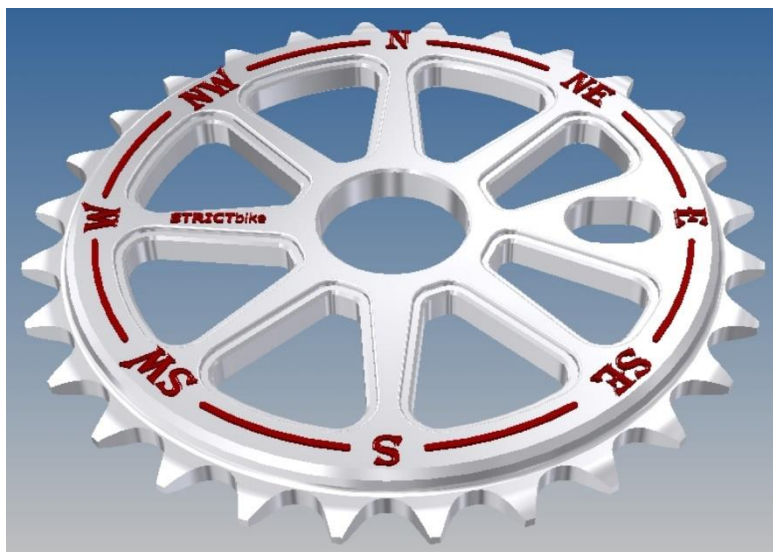
Obrázok č. 8: Výstup 3D modelu súčiastky pre potreby návrhu technologického postupu. Ozubené koleso SPOTFINDER 28T (Zdroj: Vlastné spracovanie)
