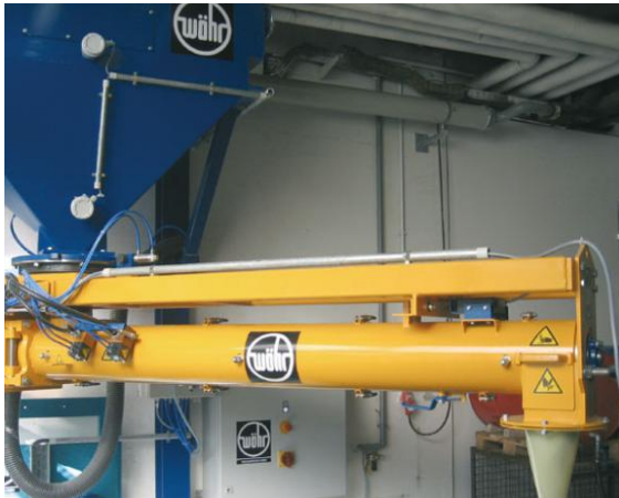
Obr. 38 Vlevo průběžný mísič a vpravo lopatkový mísič pro přípravu formovací směsi [68; 69].
