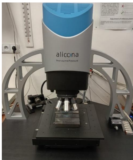
Obr. 76 Měření zkušební vzorku pomocí bezdotykového optického mikroskopu Alicona.
