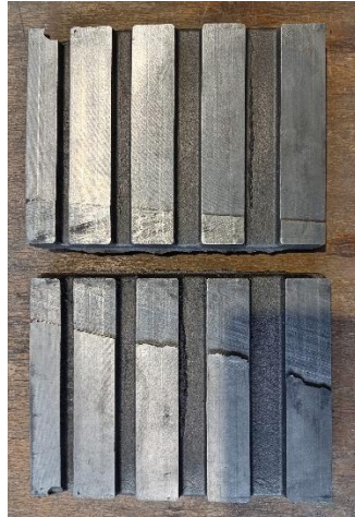
Obr. 78 Rozříznutý zkušební odlitek na dvě části.
