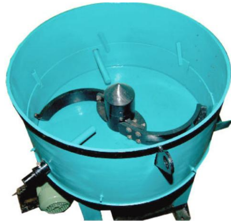
Obr. 38 Vlevo průběžný mísič a vpravo lopatkový mísič pro přípravu formovací směsi [68; 69].
