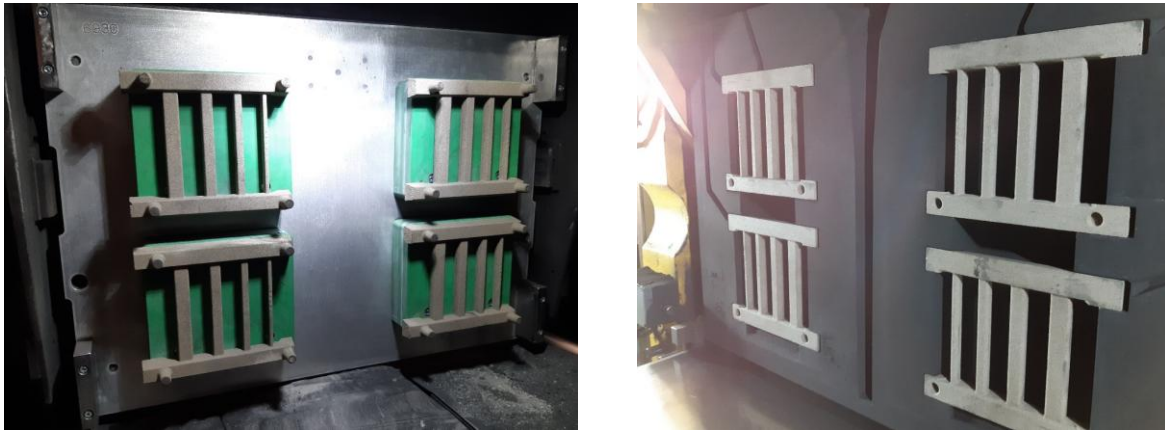
Obr. 54 Zakladač jader se zkušebními jádry (vlevo) a jádra uložená ve formě (vpravo).
