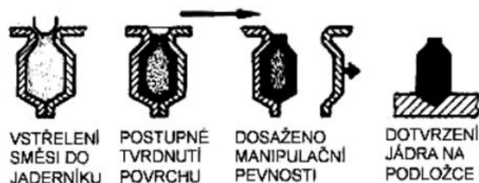
Obr. 35 Postup vytvrzování jádra [61].
