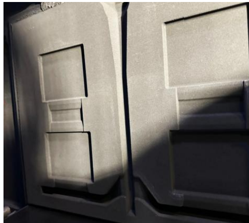
Obr. 55 Zadní část formy s vtokovou soustavou
