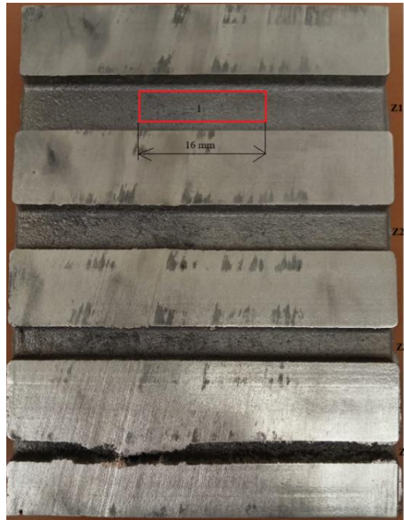
Obr. 79 Rozvržení měření na rozřezaném zkušební vzorku směs č.1.
