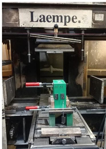
Obr. 48 Cold-boxová vstřelovačka Laempe 2.
