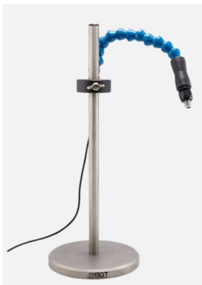
Obrázek 2.12: Senzor teploty listu [16]
