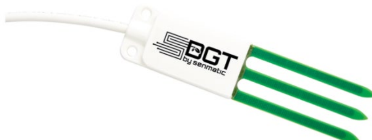
Obrázek 2.11: Kombinovaný půdní senzor Senmatic [15]
