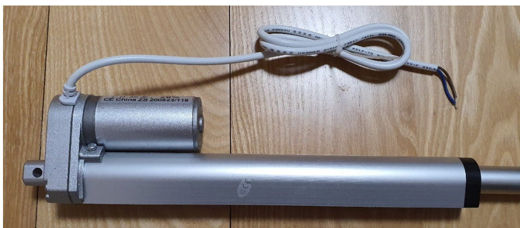
Obrázek 4.14: Použitý lineární pohon. Foto Jiří Šindelář
