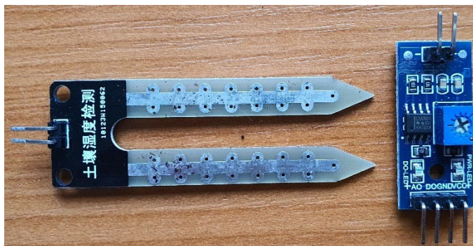
Obrázek 4.9: Použitý senzor vlhkosti půdy s komparátorem LM393. Foto Jiří Šindelář
