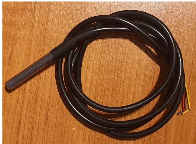
Obrázek 4.5: Teploměr Dallas DS18B20. Foto Jiří Šindelář
