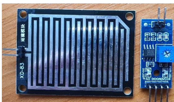
Obrázek 4.7: Senzor deště s komparátorem LM393. Foto Jiří Šindelář
