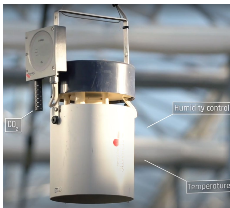
Obrázek 2.8: Kombinovaný senzor RTFC-7 [12]
