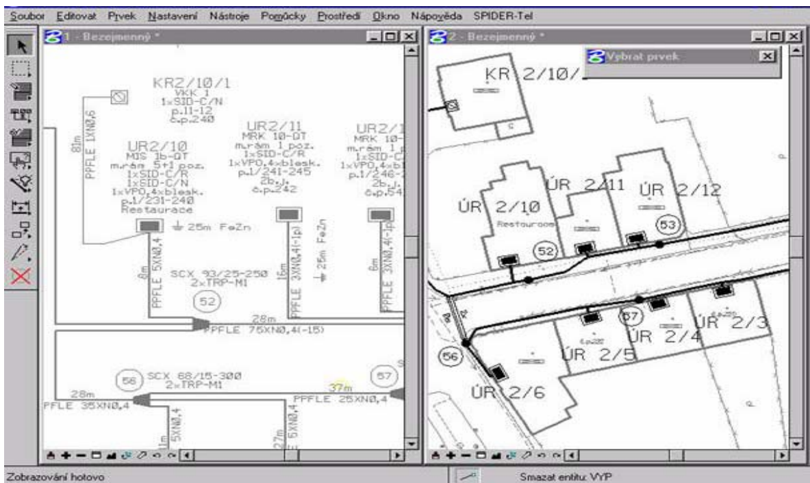
Obr. 3.3: Ukázka počítačově zpracovaného průběhu optické sítě v různých režimech
