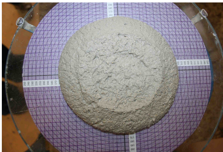
Obr. č. 8 (a, b) Střásací stolek včetně kovového kužele, rozlitý maltový kužel
