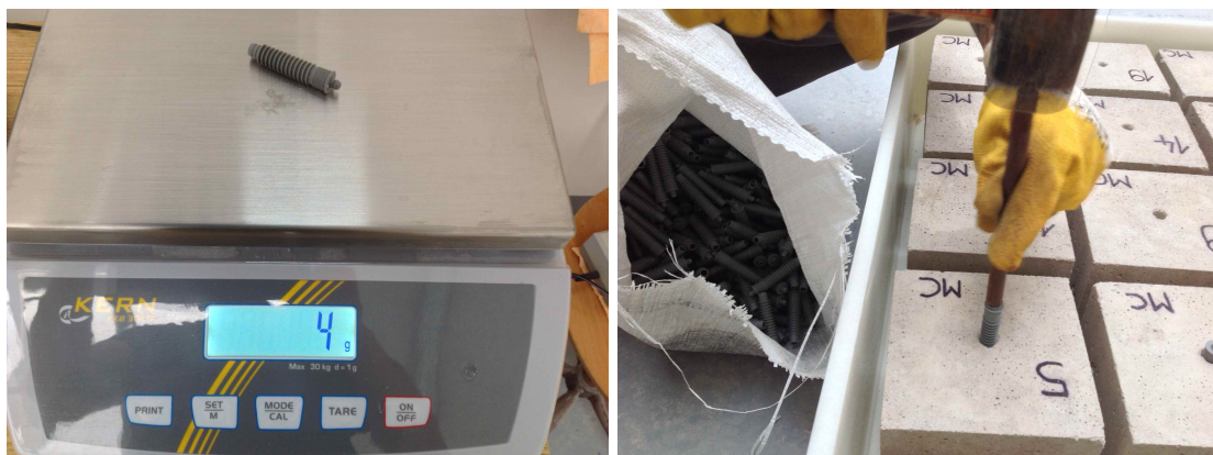
Obr. č. 20 (a, b) Plastový pakr – vážení a osazení do vzorku
