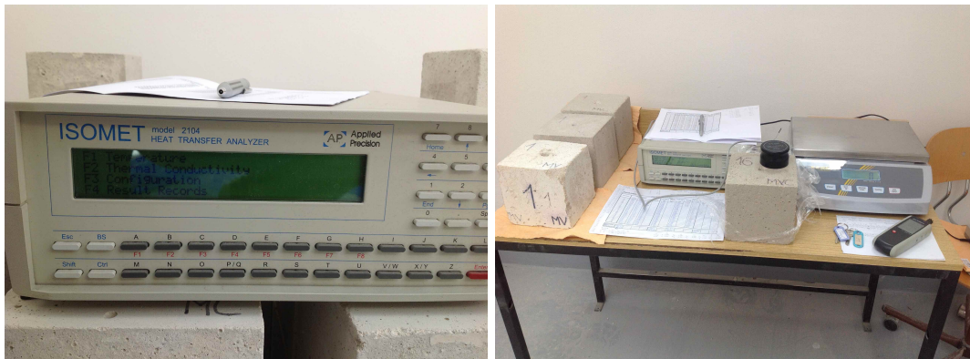
Obr. č. 15 (a, b) Měření součinitele tepelné vodivosti \lambda pomocí přístroje ISOMET - model 2104
