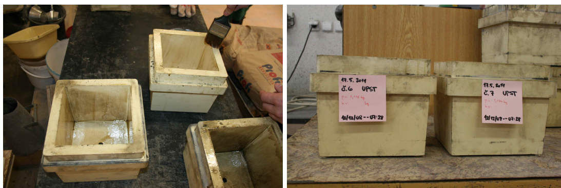
Obr. č. 9 (a, b) Příprava forem na maltové krychle – vytření, označení
