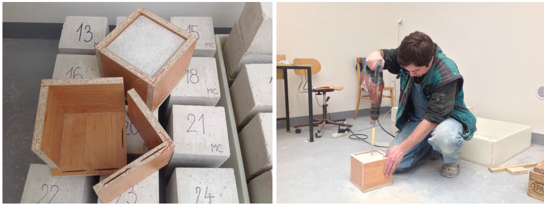
Obr. č. 12 (a, b) Vrtání maltových krychlí
