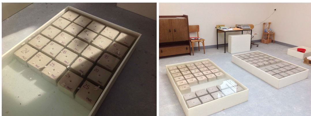
Obr. č. 14 (a, b) Vlhčení maltových krychlí
