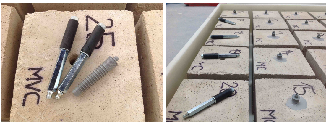
Obr. č. 23 (a, b) Kovové pakry s pevnou a volnou kuličkou a pakt plastový, osazení kovových paktů do vzorků, původně určených jako referenčních
