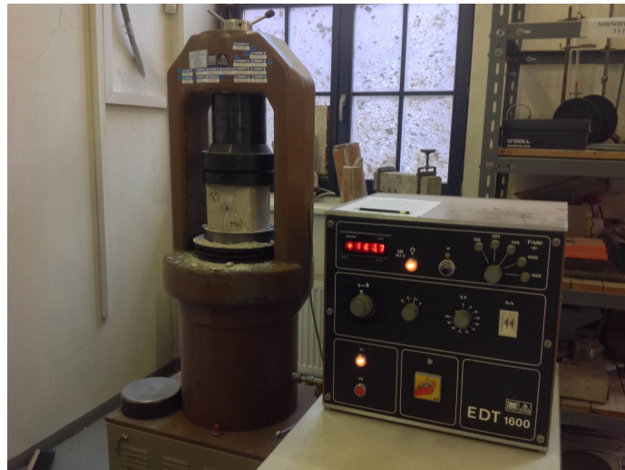
Obr. č. 26 Hydraulický lis sloužící ke zkoušení krychelné pevnosti v tlaku
