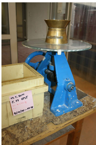
Obr. č. 8 (a, b) Střásací stolek včetně kovového kužele, rozlitý maltový kužel
