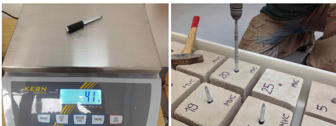
Obr. č. 21 (a, b) Kovový pakr – vážení a osazení do vzorku
