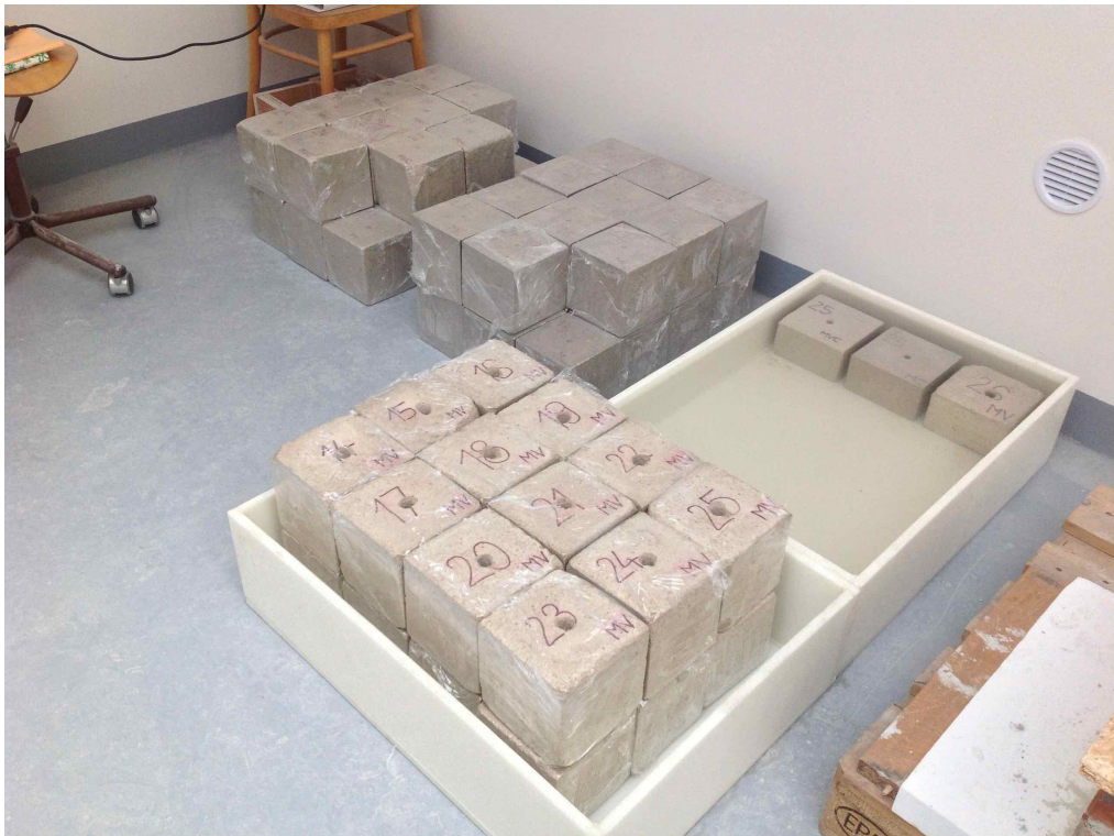
Obr. č. 16 Vzorok požadovaného stupně zavlhčení zabaleny ve fólii a připraveny k měření \lambda
