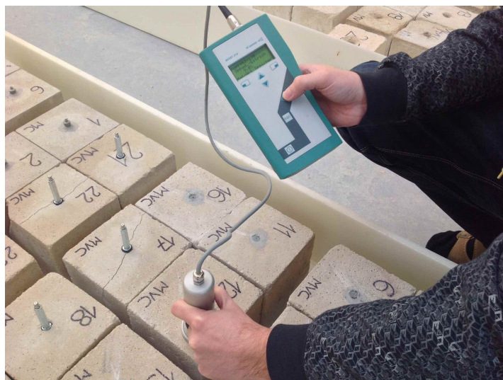
Obr. č. 5 Měření vlhkosti vlhkoměrem
