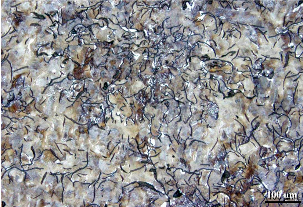
Obr. 5: Mikrostruktura perliticko-feritické LLG, leptadlo NITAL [8]
