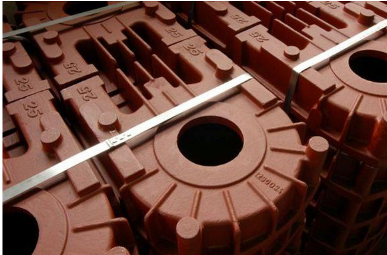
Obr. 28: Víko skříně převodovky z LLG 25, povrchově upravené akrylátovým lakem [12]
