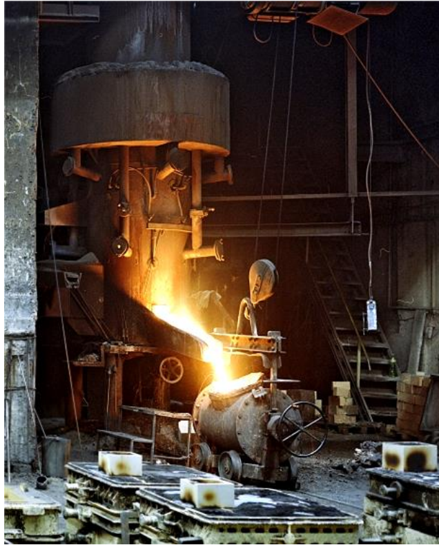
Obr. 8: Odpich litiny z kuplovný [12]
