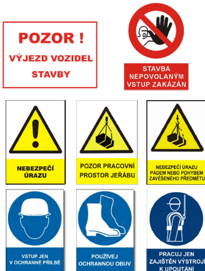
Obrázek 59 - Cedule s upozorněními při vstupu na staveniště
