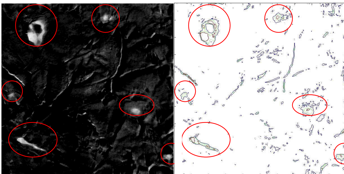
Obr. 7-10. Porovnání zobrazení rozdílového obrazu v odstínech šedi a pomocí vrstevnicového zobrazení pro snadnější identifikaci silných projevů nabíjení.
