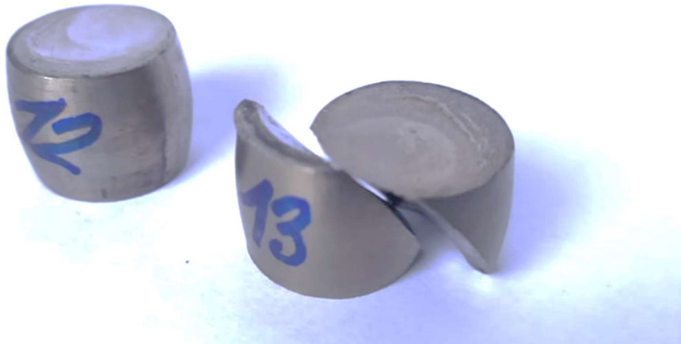
Obr. 37 Vzorek č. 12 a vzorek č. 13 po pēchování.
