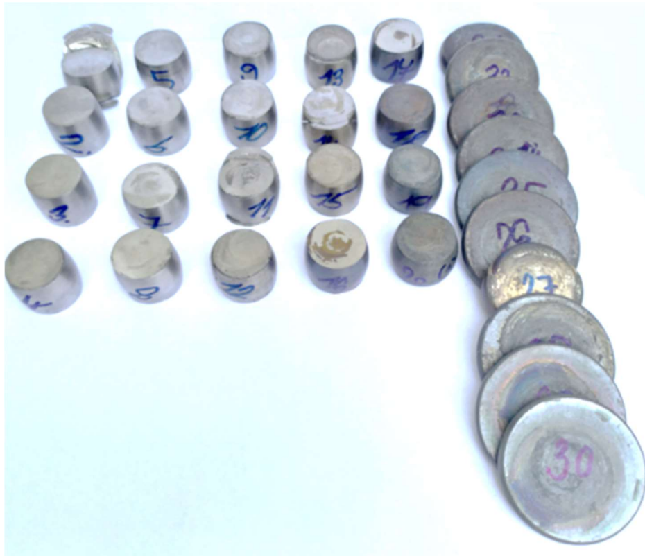
Obr. 51 Pěchované vzorky ze slitiny VT 3-1.
