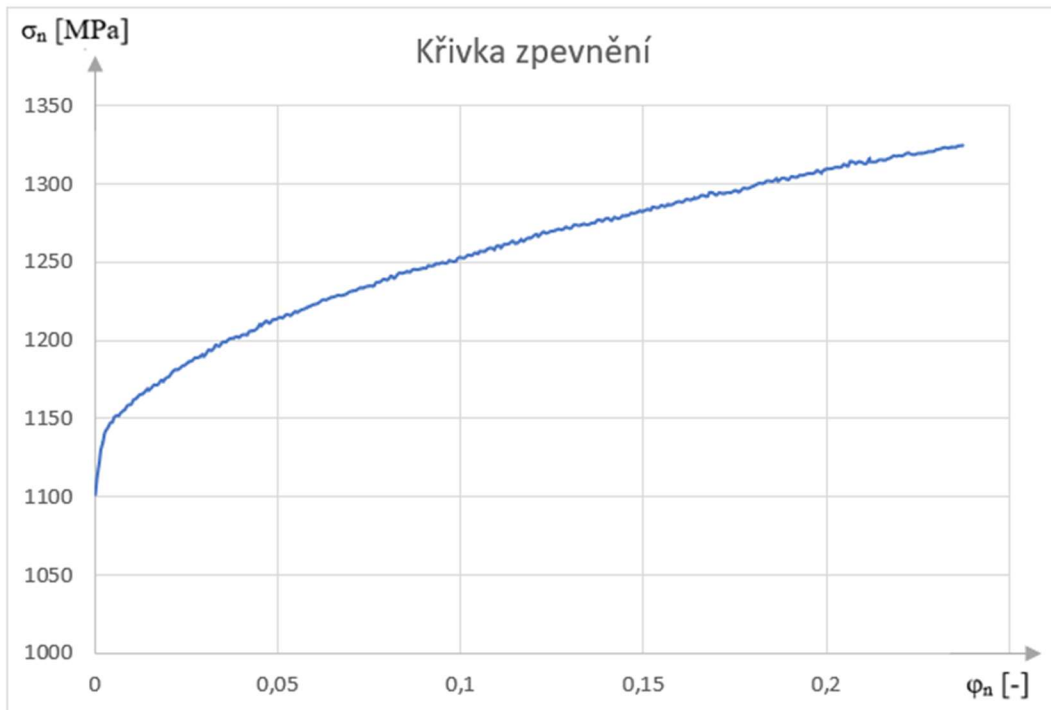
Obr. 42 Křivka zpevnění pro teplotu 25 °C.
