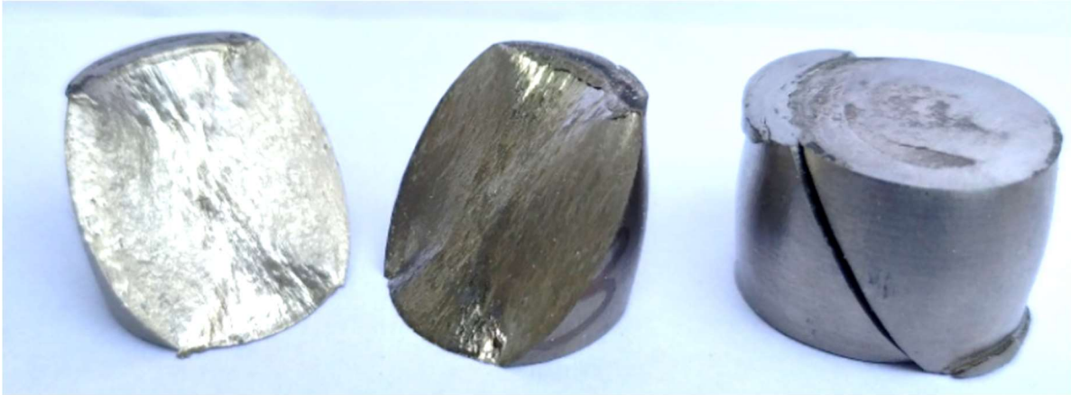
Obr. 53 Tvárný lom u vzorku č. 11
