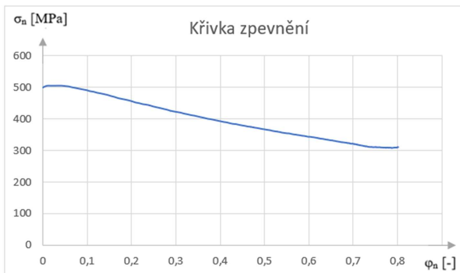
Obr. 49 Křivka zpevnění pro teplotu 700 °C.
