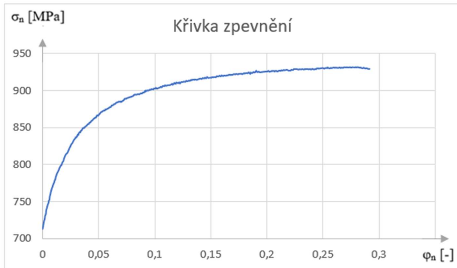
Obr. 47 Křivka zpevnění pro teplotu 500 °C.
