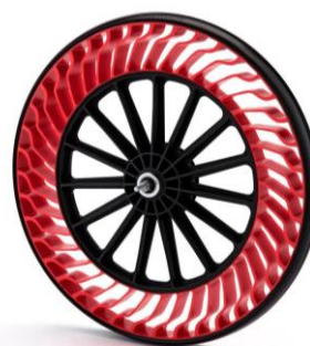
Obr. 6-1 a) Prototyp Uptis od Michelin, b) Bezdušová pneumatika od Bridgestone [66] [67]
