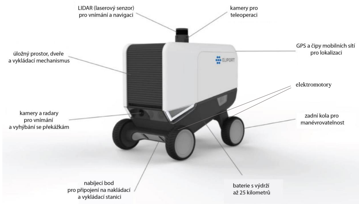
obr. 2-20 Schéma dílčích komponent konceptu Eliport [34]
