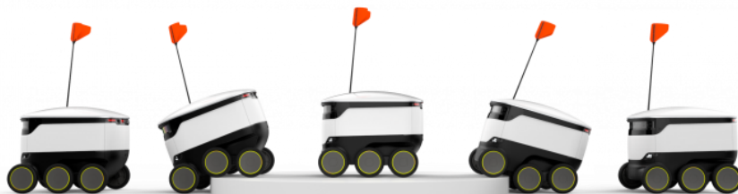
obr. 2-23 Robot Starship – překonávání obrubníku [41]
