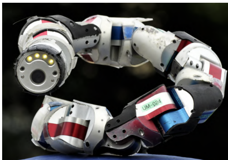
Obr. 18: Stromolezecký robot vytvorený tímom z Biorobotics Lab
