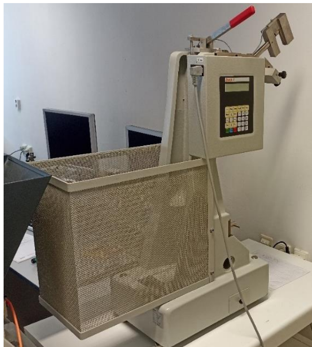
Obrázek 10.3 Zařízení použité pro měření houževnatosti Zwick 5113.100 [vlastní zdroj]
