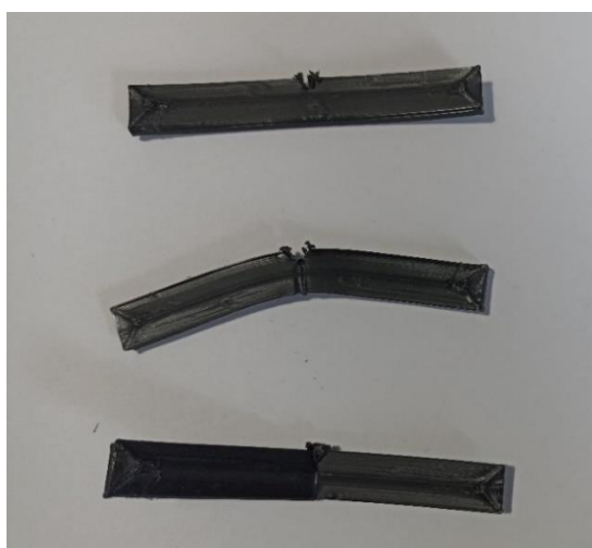
Obrázek 10.6 Nepřeražené nedegradované vzorky z PLA měřené při teplotě 70 °C při zkoumání vrubové houževnatosti [vlastní zdroj]
