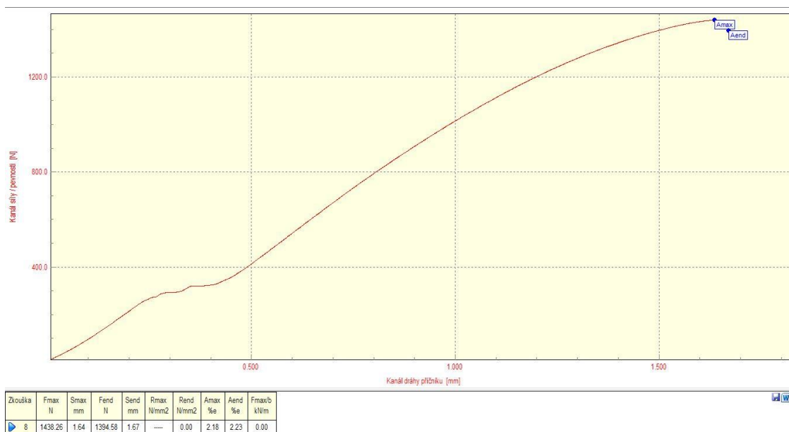
Obrázek 12.23 Deformační křivka vzorku č. 23 nedegradovaného PA6 CF15 [vlastní zdroj]
