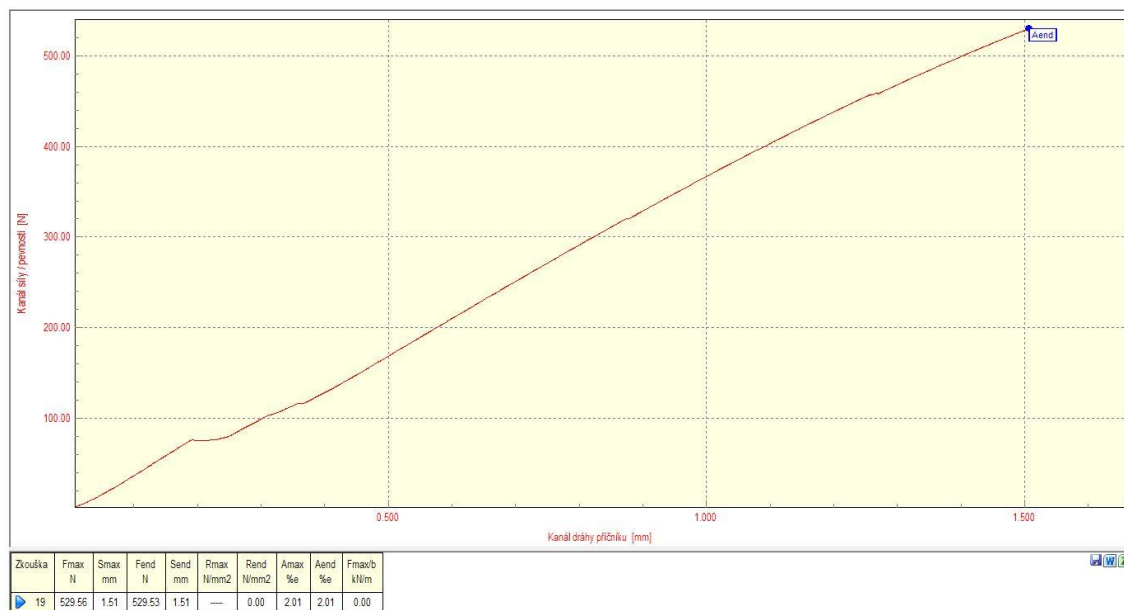
Obrázek 12.18 Deformační křivka vzorku č. 18 degradovaného PLA [vlastní zdroj]
