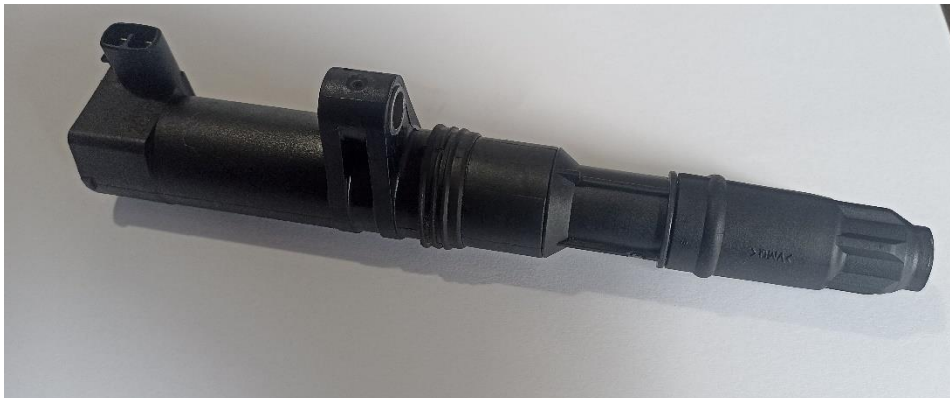
Obrázek 11.1 Referenční úchyt zapalovací cívky sloužící pro vytvoření digitálního modelu [vlastní zdroj]
