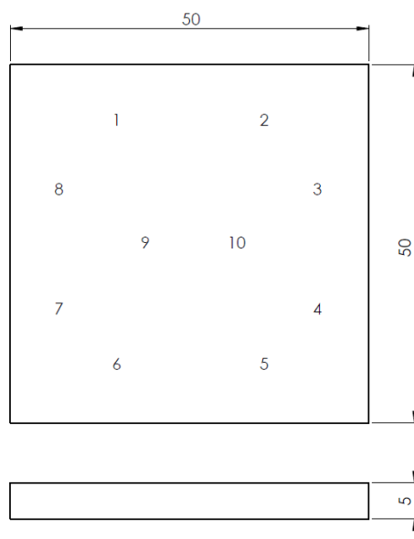
Obrázek 10.8 Výkres vzorku pro měření tvrdosti s vyznačenými body pro měření [vlastní zdroj]
