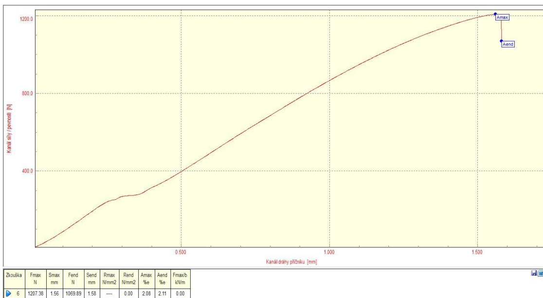
Obrázek 12.35 Deformační křivka vzorku č. 35 degradovaného PA6 CF15 [vlastní zdroj]
