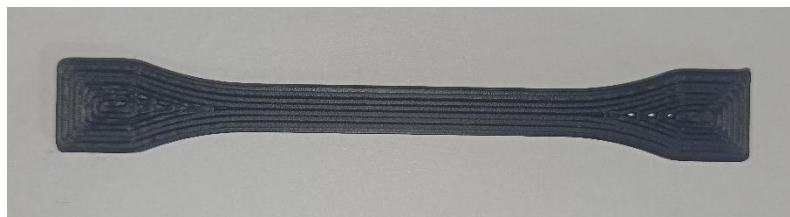
Obrázek 9.2 Detail nepřetrženého vadného vzorku pro měření pevnosti v tahu [vlastní zdroj]
