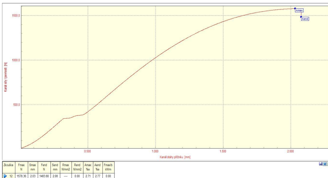
Obrázek 12.27 Deformační křivka vzorku č. 27 nedegradovaného PA6 CF15 [vlastní zdroj]
