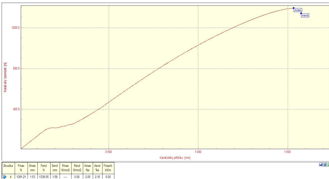
Obrázek 12.21 Deformační křivka vzorku č. 21 nedegradovaného PA6 CF15 [vlastní zdroj]
