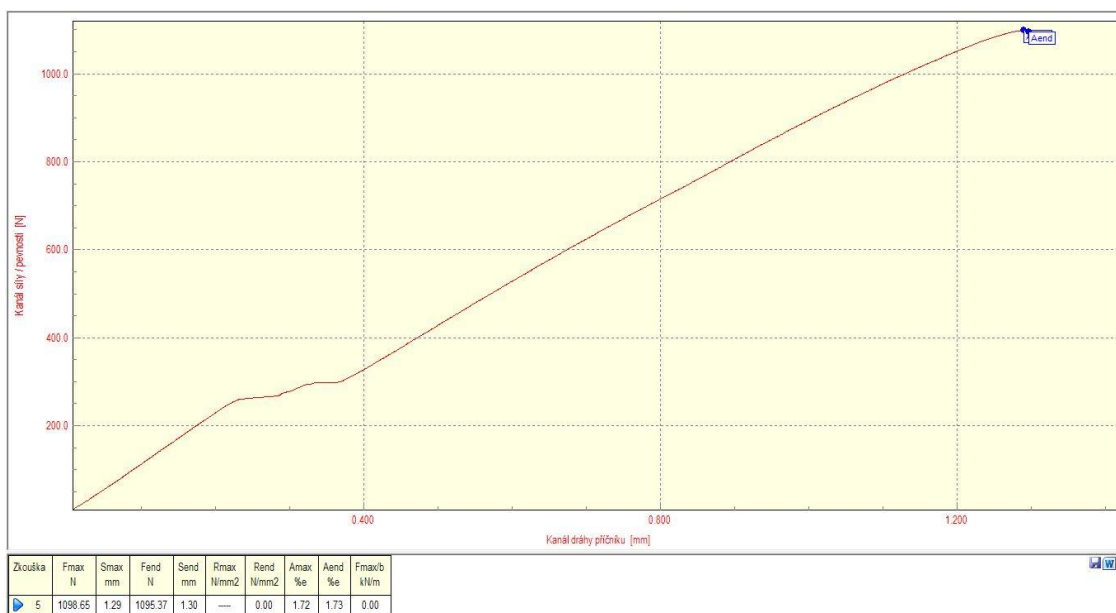
Obrázek 12.34 Deformační křivka vzorku č. 34 degradovaného PA6 CF15 [vlastní zdroj]
