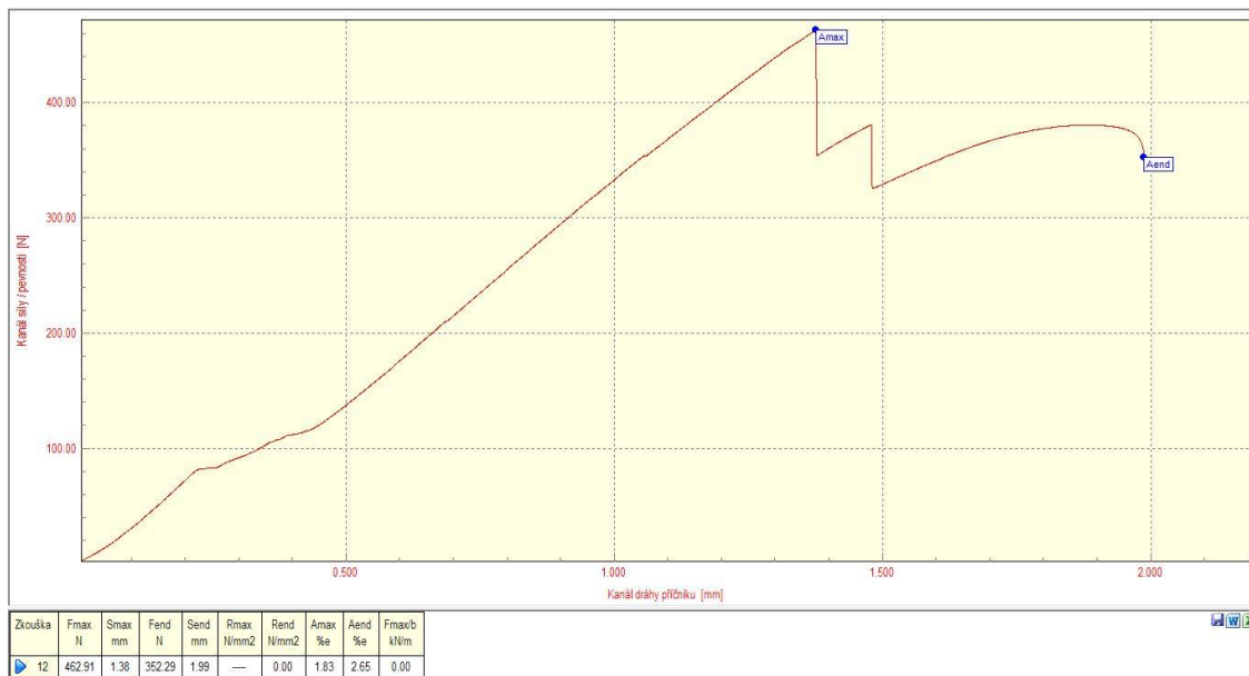
Obrázek 12.11 Deformační křivka vzorku č. 11 degradovaného PLA [vlastní zdroj]
