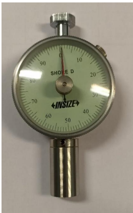
Obrázek 10.7 Tvrdoměr značky Insize se stupnicí Shore D [vlastní zdroj]
