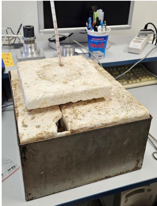
Obrázek 10.5 Dusíková komora pro ochlazování vzorků [43]
