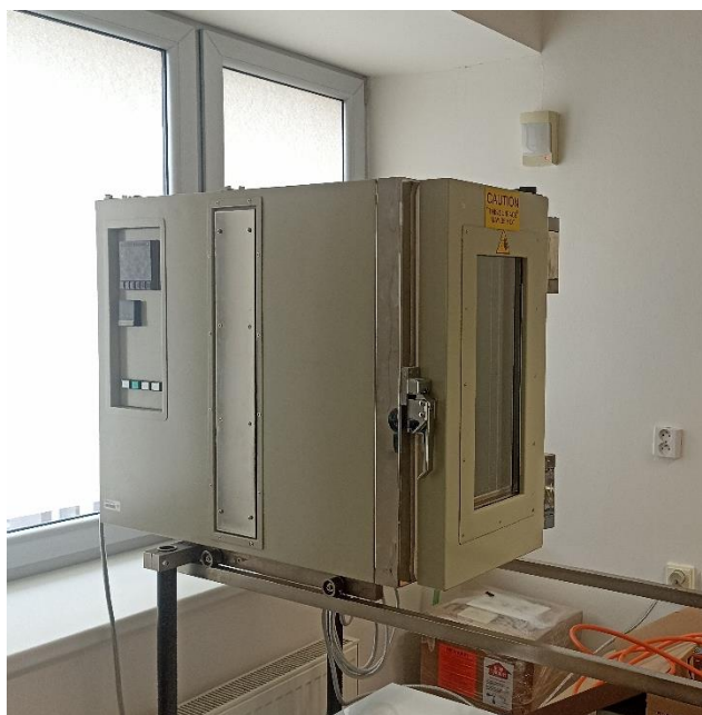
Obrázek 10.4 Horkovzdušná pec Climatic Test Systems ltd. 91250 [vlastní zdroj]
