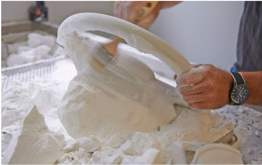
Obrázek 2.4 Čištění dílu vyrobeného pomocí SLS od přebytečného práškového materiálu [52]
