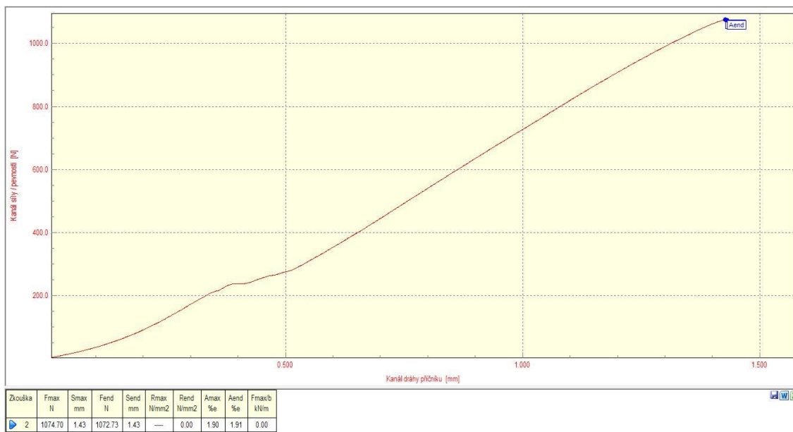
Obrázek 12.31 Deformační křivka vzorku č. 31 degradovaného PA6 CF15 [vlastní zdroj]
