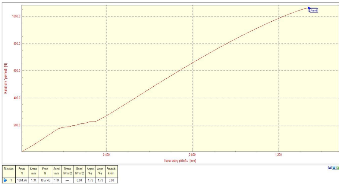
Obrázek 12.28 Deformační křivka vzorku č. 28 degradovaného PA6 CF15 [vlastní zdroj]
