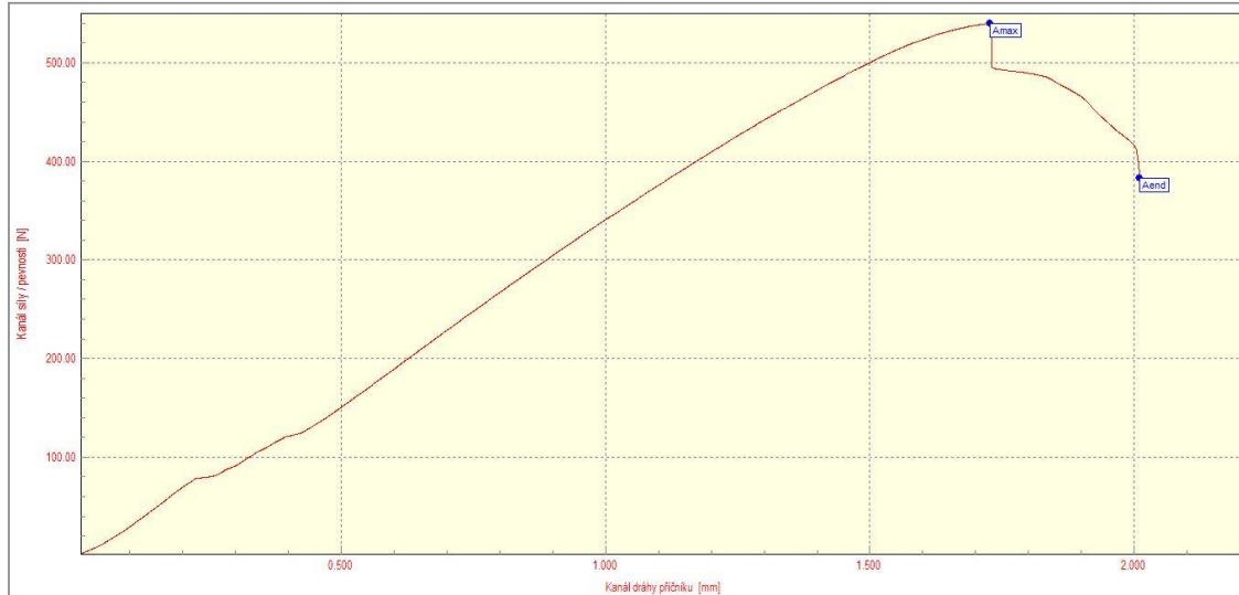
Obrázek 12.1 Deformační křivka vzorku č. 1 nedegradovaného PLA [vlastní zdroj]
