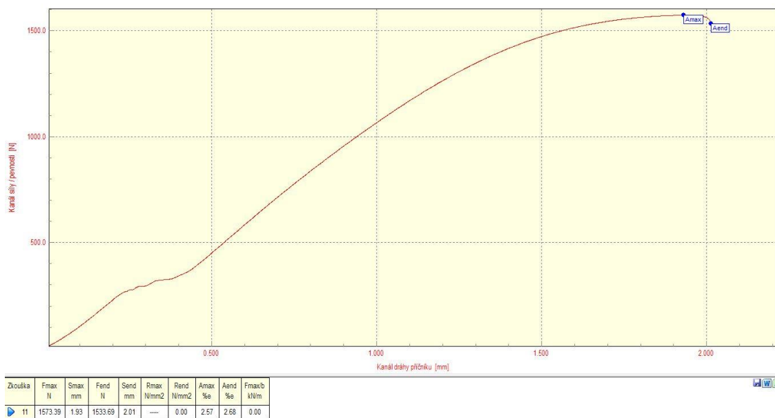
Obrázek 12.26 Deformační křivka vzorku č. 26 nedegradovaného PA6 CF15 [vlastní zdroj]
