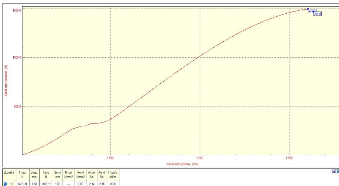
Obrázek 12.25 Deformační křivka vzorku č. 25 nedegradovaného PA6 CF15 [vlastní zdroj]
