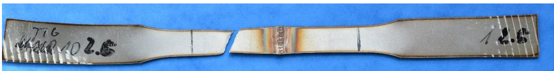
Obr. 68 Vzorek 2.6 po tahové zkoušce.
