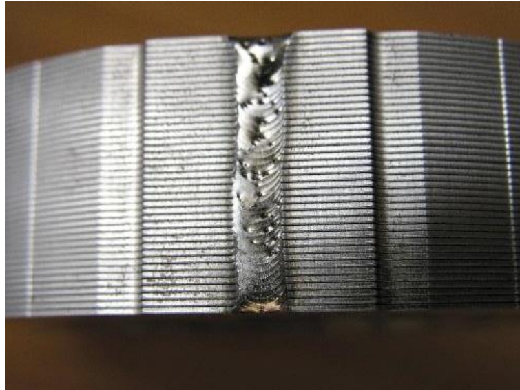
Obr. 23 Svarový spoj s porezitou [36].
