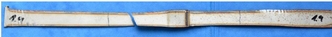
Obr. 70 Vzorek 1.9 po tahové zkoušce.
