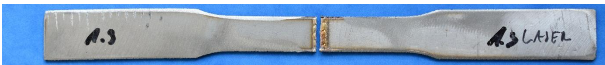
Obr. 64 Vzorek 1.3 po tahové zkoušce.
