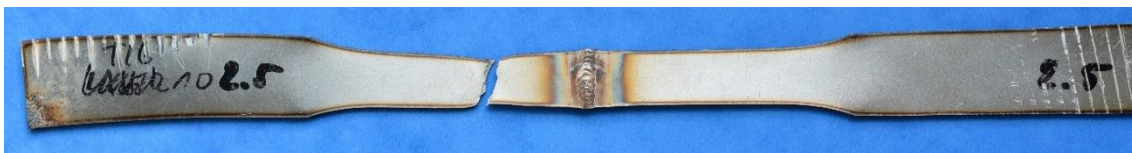
Obr. 67 Vzorek 2.5 po tahové zkoušce.
