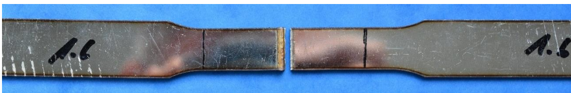
Obr. 66 Vzorek 1.6 po tahové zkoušce.
