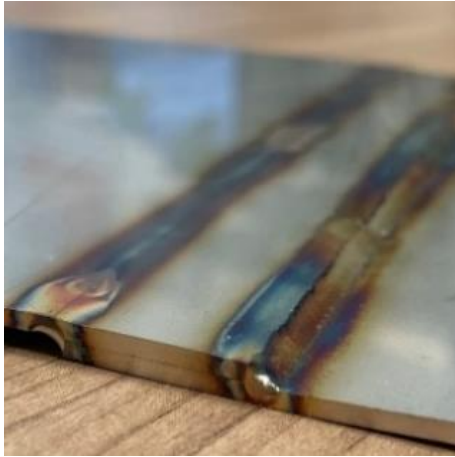
Obr. 44 Koutový překlátovaný svar metodou TIG.
