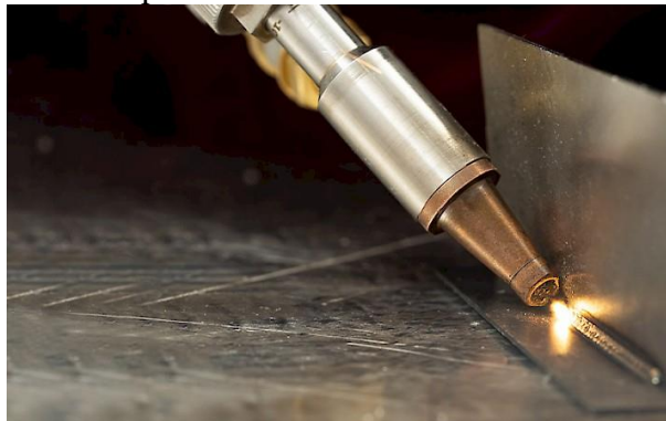
Obr. 27 Schéma laserového svařování [44].
