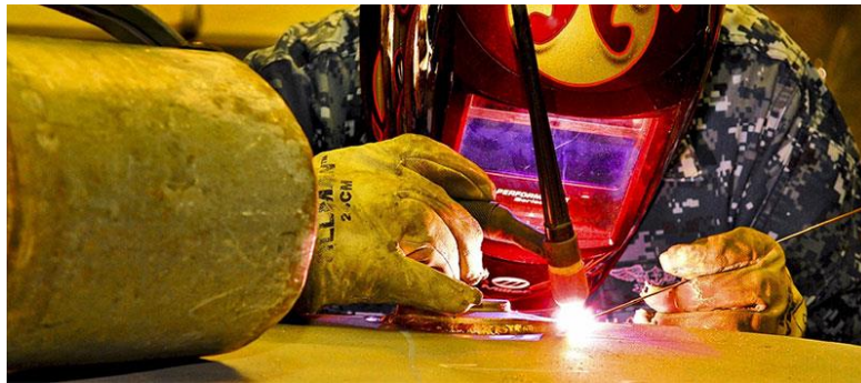
Obr. 4 Technologie svařování TIG [14].
