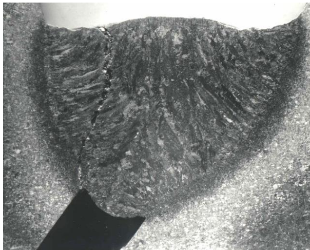
Obr. 21 Svarový spoj s trhlinou za horka [35].
