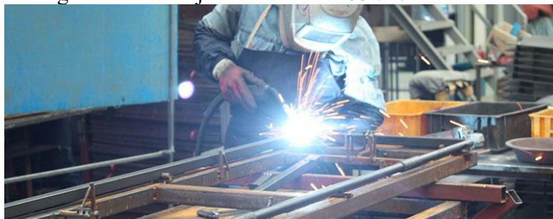
Obr. 2 Technologie svařování MIG [14].
