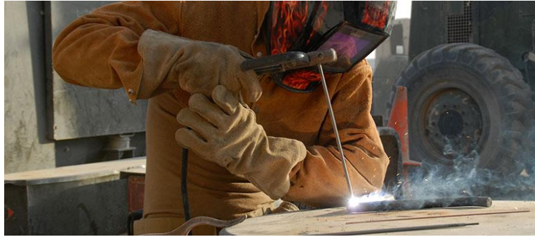
Obr. 3 Technologie svařování MMA [14].
