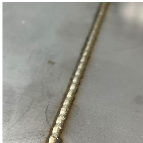
Obr. 43 Tupý svár metodou laserového paprsku.
