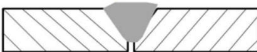
Obr. 22 Svarový spoj s neprovařeným kořenem [34].
