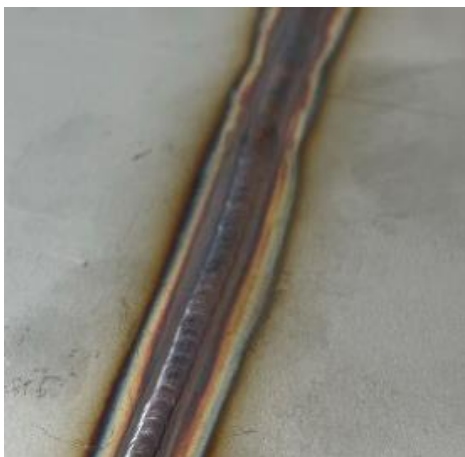
Obr. 41 Tupý svár na metodou TIG.
