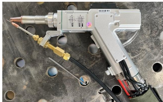
Obr. 31 Svařovací pistole pro laserové svařování.
