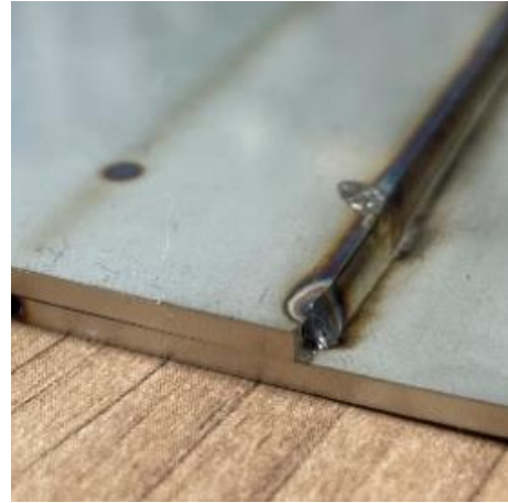
Obr. 45 Koutový překlátovaný svar metodou laserového paprsku.
