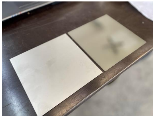
Obr. 28 Polotovary pro svařování experimentu.
