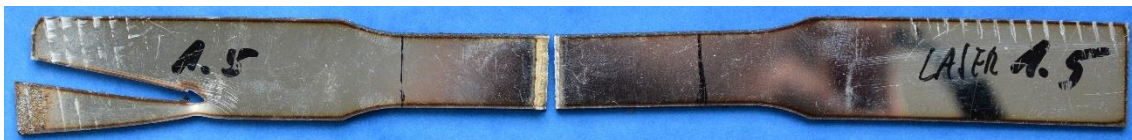
Obr. 65 Vzorek 1.5 po tahové zkoušce.
