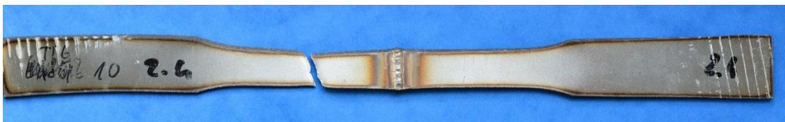
Obr. 58 Vzorek 2.4 po tahové zkoušce.
