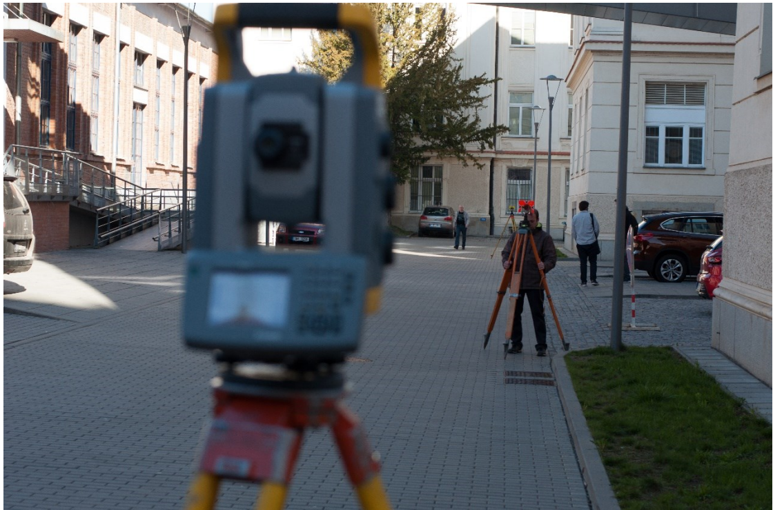
Obr. 9 Zaradovanie hranolov do priamky totálnou stanicou Trimble S6 [autor]
