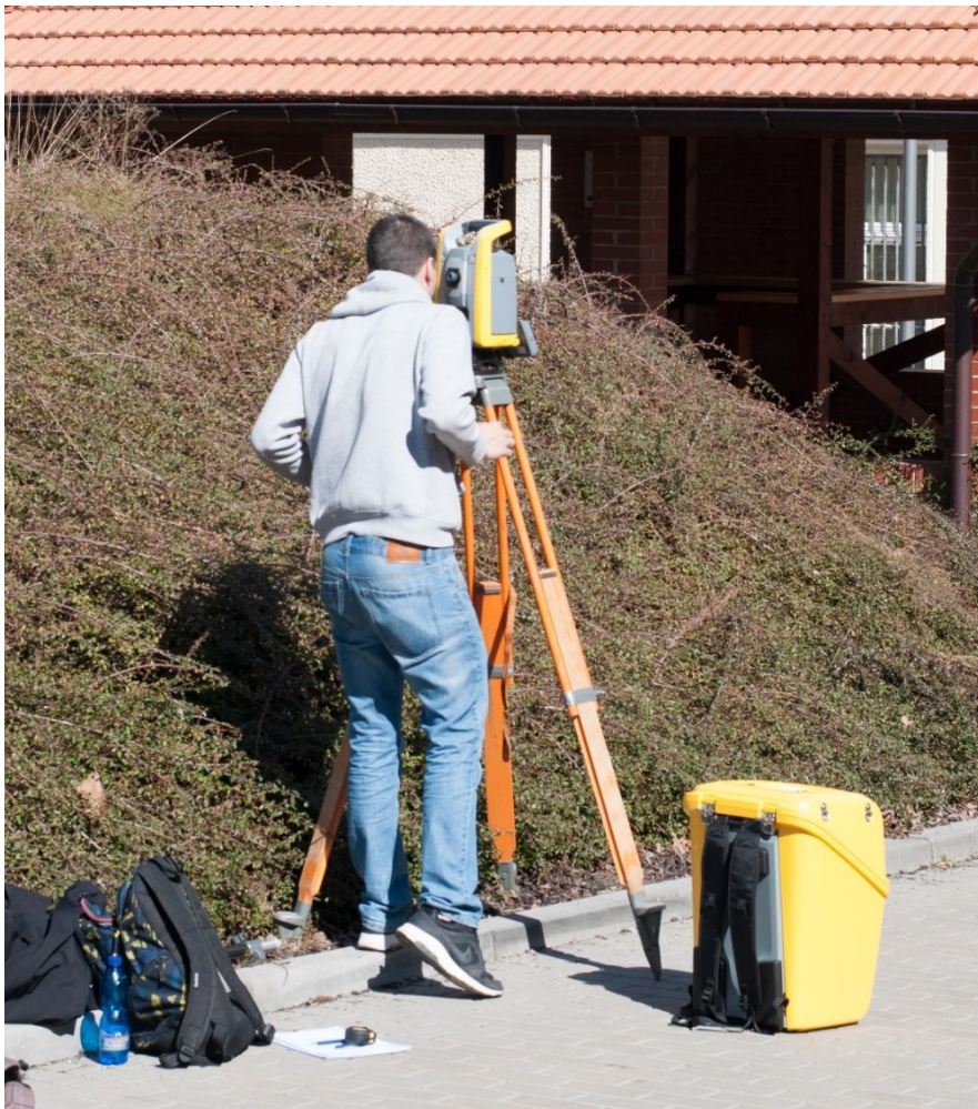
Obr. 12 Meranie pomocnej meračskej siete a podrobných bodov [autor]
