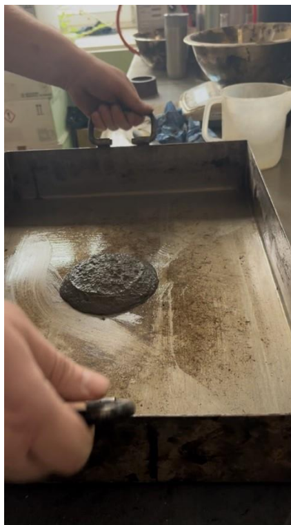
Obrázek 44: Ruční střásání cementové malty
