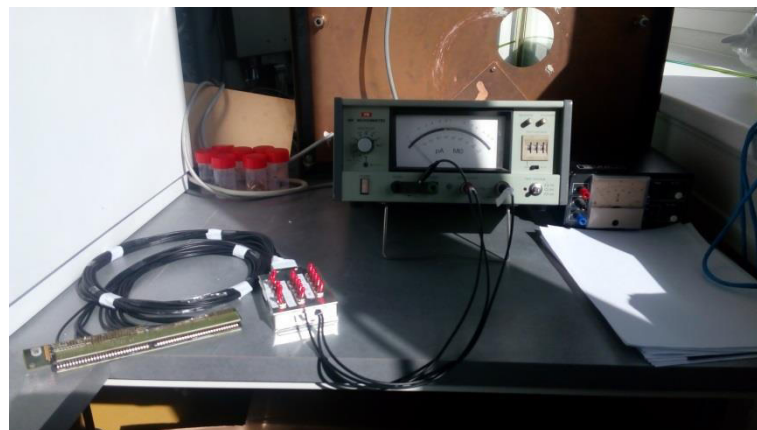
Obr. 21 Snímek pracoviště při měření povrchového izolačního odporu
