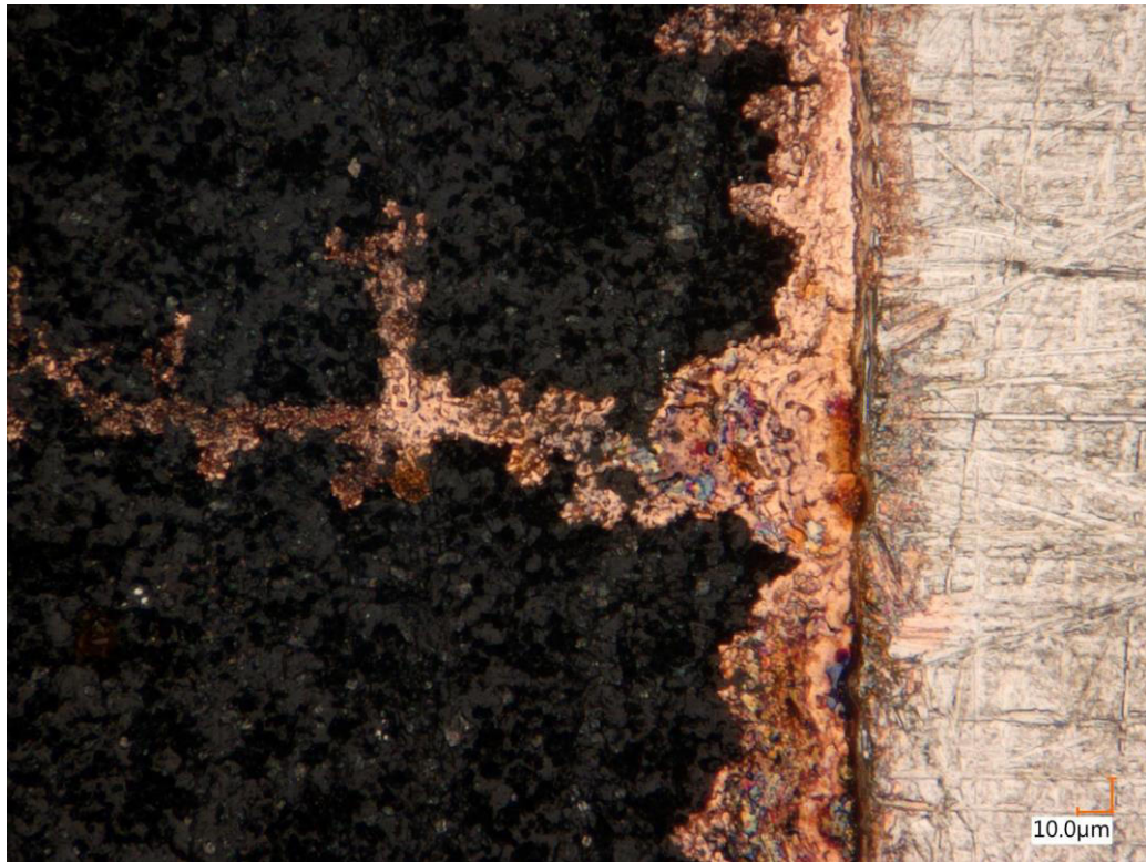
Obr 34 Snímek dendritu na straně anody.
