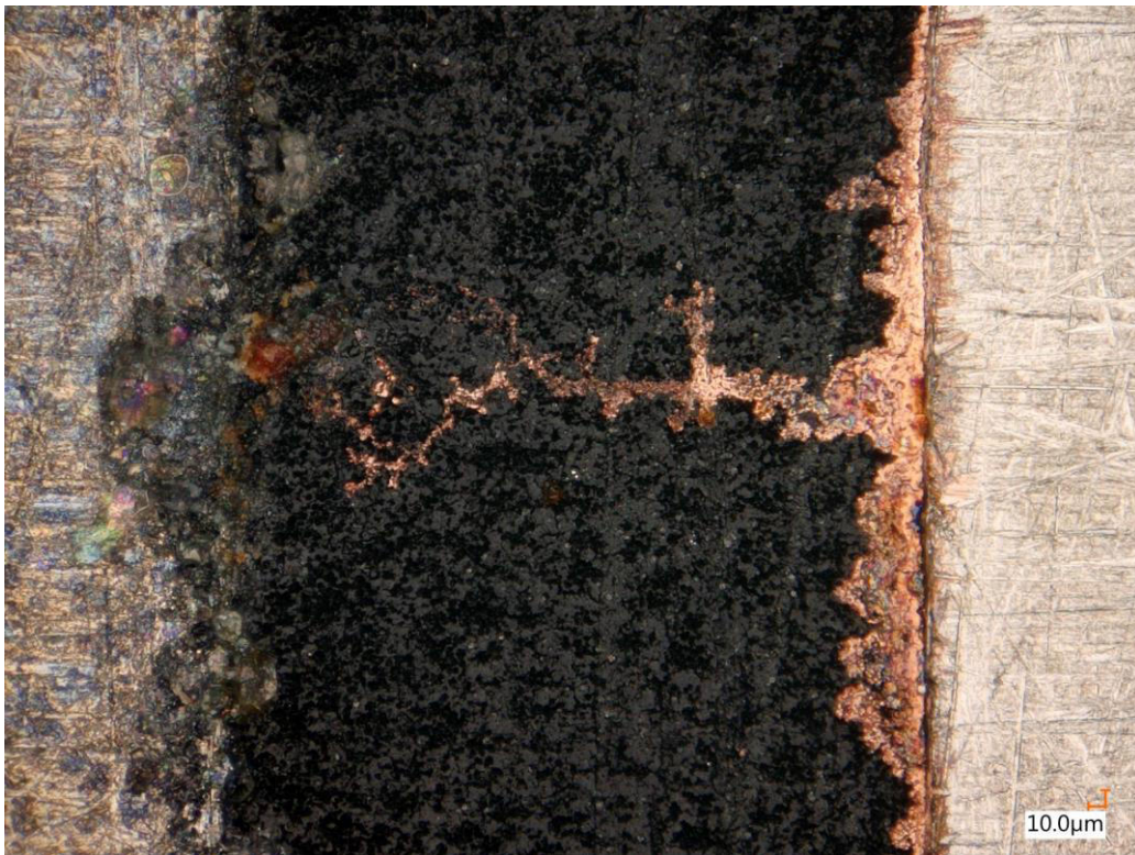
Obr 32 Snímek dendritu na testovací DPS.
