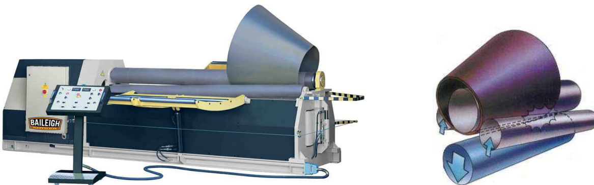
Obr. 21 Zakružování kuželů na čtyřválcové zakružovačce [10], [14]
