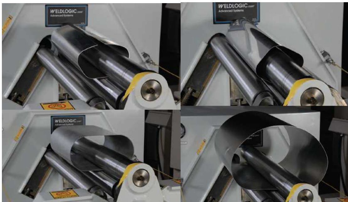
Obr. 28 Tvary zakroužené pomocí CNC [11]
