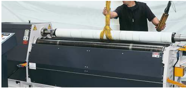
Obr. 44 Zařízení pro vyjmutí hotového výrobku [15]
