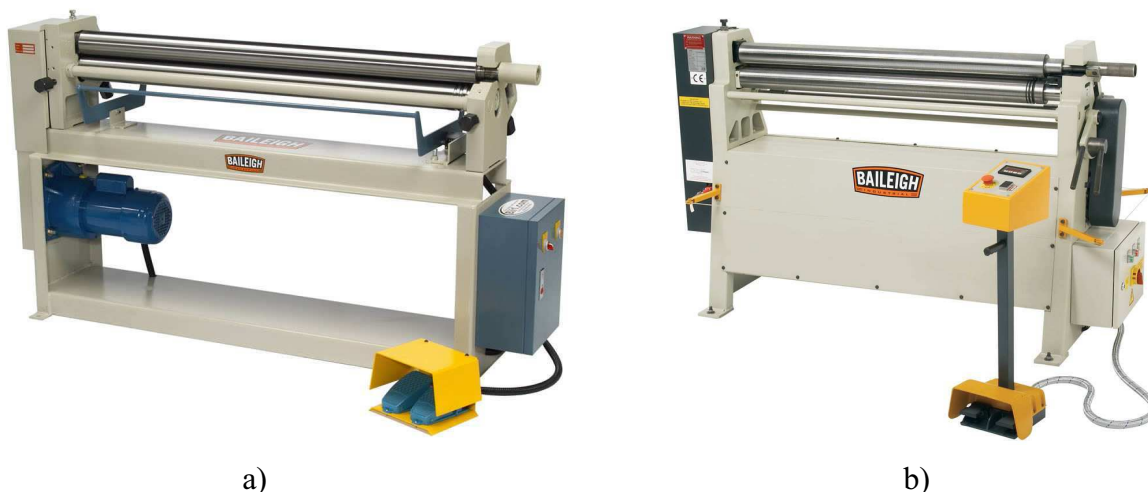
Obr. 12 Motorové zakružovačky s ručně a motoricky ovládaným zadním válcem [10]
