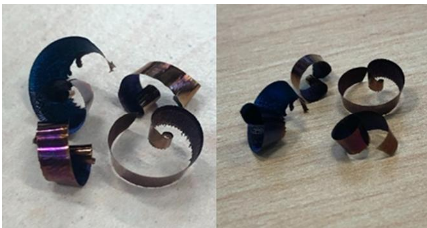
Obr. 44 Třísky vzniklé při hloubce řezu a_p 0,5 mm.
