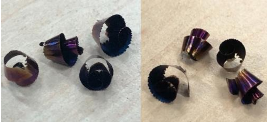
Obr. 43 Třísky vzniklé při hloubce řezu a_p 0,2 mm.
