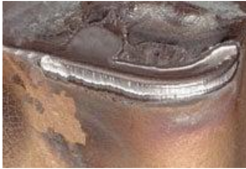
Obr. 3 Abrasivní opotřevení na hřbetu [8].
