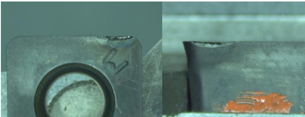
Obr. 50 Vzorek E4 vylomený hlavní břit v 16,4 min, vlevo čelo, vpravo hřbet.
