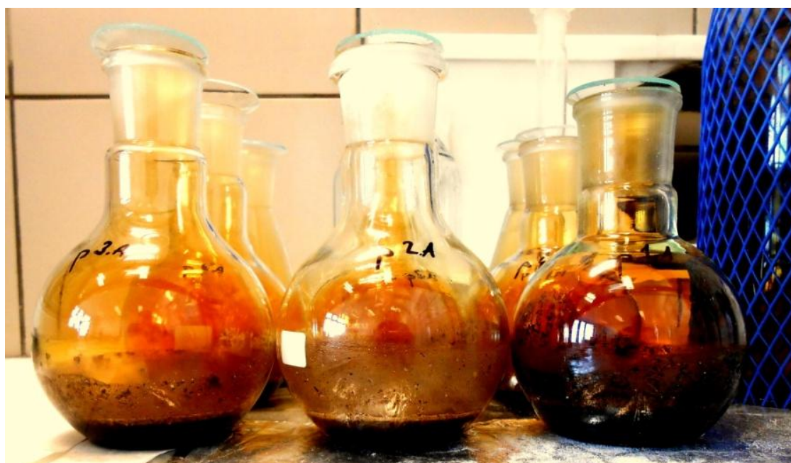
Obrázek 15: Louhování vzorku koncentrovanou kyselinou dusičnou
