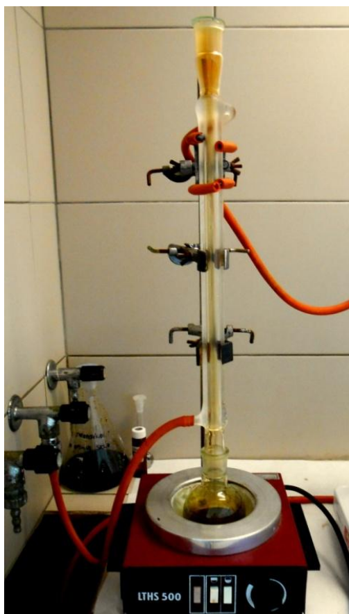
Obrázek 16: Var směsi vzorku a kyselin pod zpětným chladičem.
