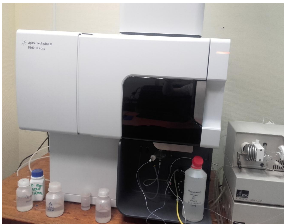
Obrázek 22: Přístroj ICP-OES od Agilent Technologies 5100
